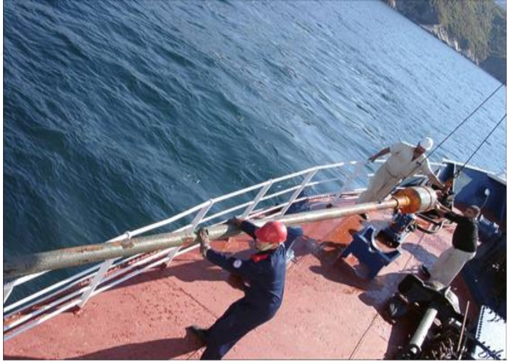
Şekil 3.1 Şarköy Kanyonu'ndan 2002 yılında MTA SİSMİK-1 Araştırma Gemisi ile ağırlıklı serbest düşmeli sediment karotlarının alınması
