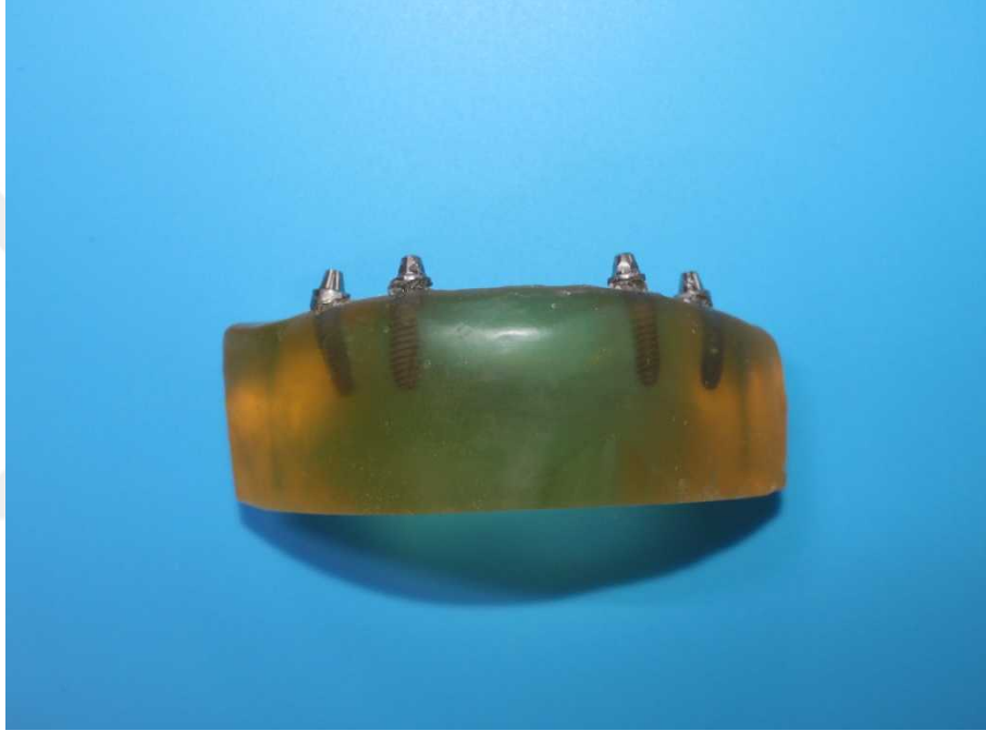
Şekil 2.3. İmplantlarla birlikte elde edilen fotoelastik model.
