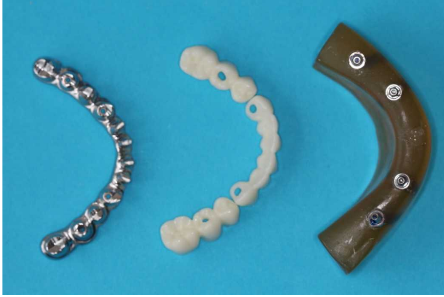
Şekil 2.7. Cr/Co altyapı, üstyapı ve implant yerleştirilmiş fotoelastik model.
