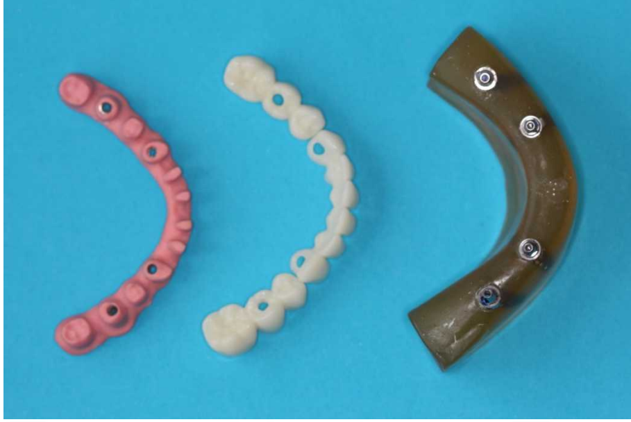
Şekil 2.9. Fiber altyapı, üstyapı ve implant yerleştirilmiş fotoelastik model.
