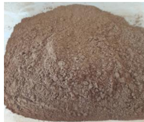
Şekil 3.8. Alkali işlem sonrası 63 µm partikül boyutundaki findık kabuğu
