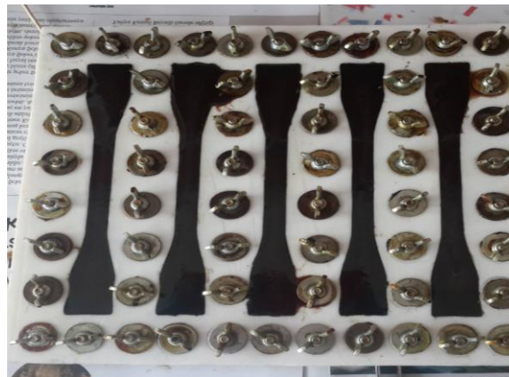
Şekil 3.12. Kalıba dökülmüş epoksi kompozit numuneleri
