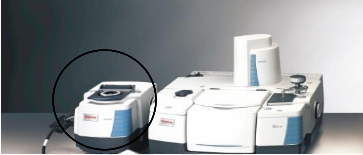
Şekil 3.6. Çalışmada kullanılan IR spektrometrenin NIR modülü
