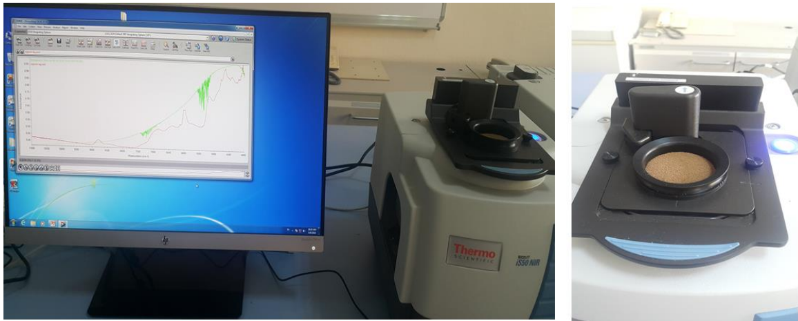
Şekil 3.8. Pestisit NIR spektralarının toplanması
