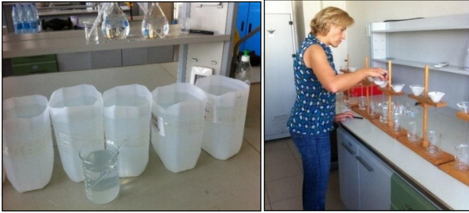
Şekil 3.7 BaSO_4 'ın çöktürülmesi ve süzülmesi
