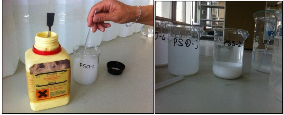
Şekil 3.4 Örneklere BaCl 2 eklenmesi ve BaCO 3 'ün çökmesi
