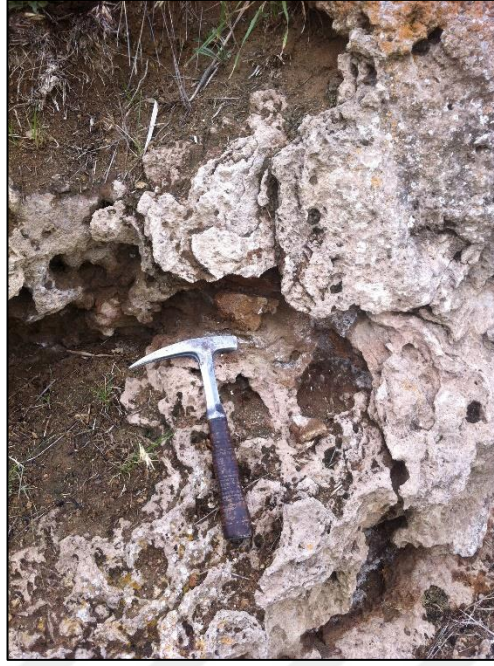
Şekil 5.19 Çağlayık'ta sıcak suların çökelttiği travertenler
