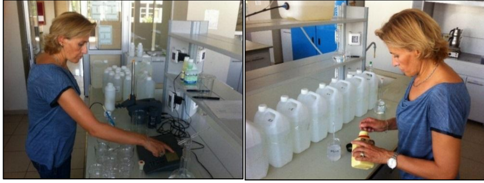
Şekil 3.6 Sülfat çöktürmek için pH'nın 4'ün altına düşürülmesi ve sulara BaCl_2 eklenmesi
