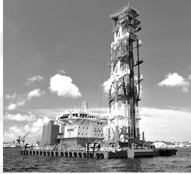
Şekil 2.11. CDM'nin denizde derin karıştırma uygulamasının ıslak yöntemi, (CDM kurumu Japon, http://www.cdm-gr.com )
