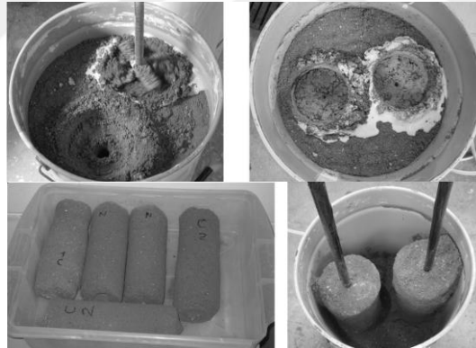
Şekil 1.7. Derin karıştırma yöntemi ile uygulanan MgO kolonları
