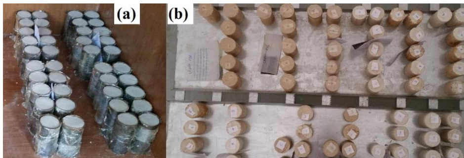
Şekil 3.3. Kürdeki numuneler (a-ilk üç gün kalıplı b- kalıpsız)
