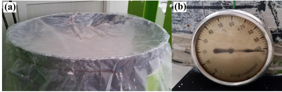
Şekil 3.16. a) Plastik örtü ile numunenin kapatılması, ve b) ortamın rutubetini ölçen higrometre
