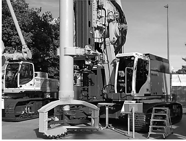
Şekil 2.22. Tek-kolon karıştırma aletinin çiftli dönme makinesi, kolon çapı 1,8 – 2,0 m ve maksimum derinlik 23,5 m (Kirsch & Bell, 2012)
