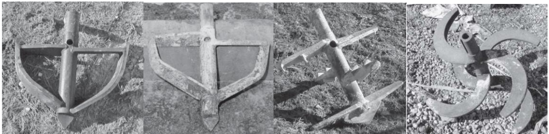
Şekil 2.18. Derin kuru karıştırmada kullanılan farklı karıştırıcılar (Kirsch and Bell 2012)
