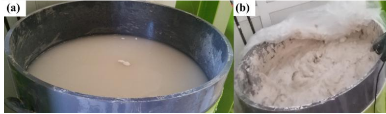
Şekil 3.11. a) Su ve CL kilinin kalıba doldurulması, b) kil-su karışımını mekanik karıştırıcı ile karıştırılması
