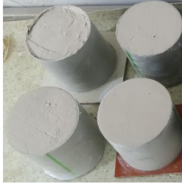
Şekil 3.7. %40 su muhtevasında CL nin kalıplara doldurulması
