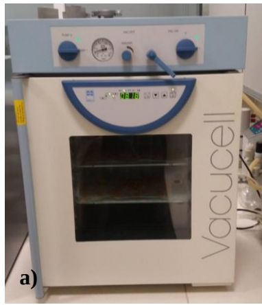
Şekil 3.9. a) Vakumlu kurutucu; b) Kamkat dilimlerinin vakumlu kurutucu tepsilerinde yerleşimi
