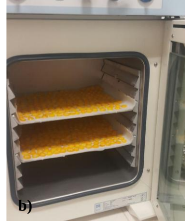
Şekil 3.9. a) Vakumlu kurutucu; b) Kamkat dilimlerinin vakumlu kurutucu tepsilerinde yerleşimi
