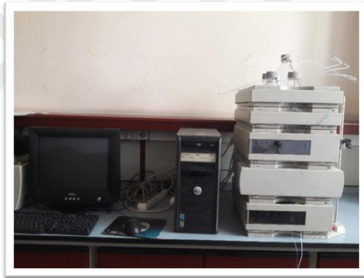
Resim 1. Agilent 1100 serisi YBSK sistemi
