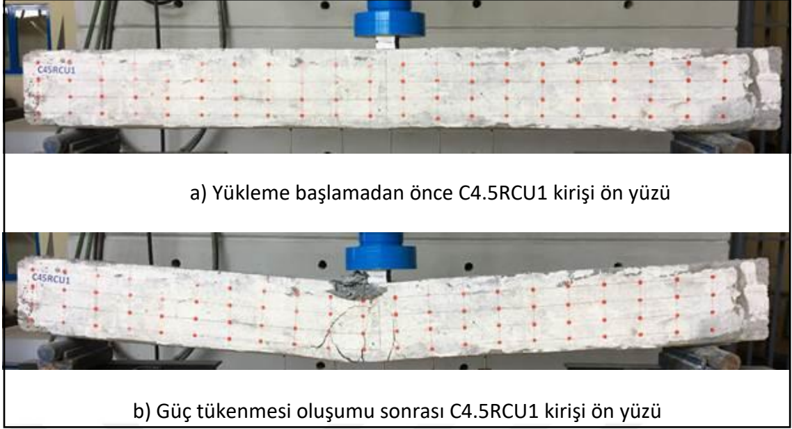
Şekil 3.3 Deney öncesi ve sonrası C4.5RCU1 kirişi görünüşleri
