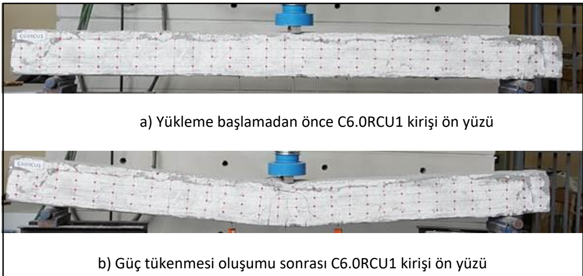
Şekil 3.4 Deney öncesi ve sonrası C6.0RCU1 kirişi görünüşleri
