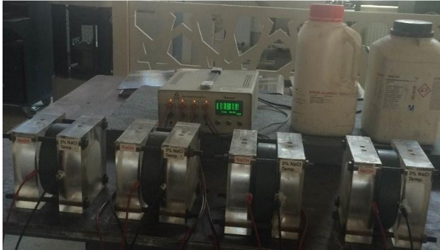
Resim 3.11. Hızlı klor geçirgenliği testi için gerekli ekipman
