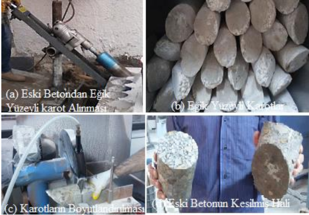
Resim 3.7. Baę dayanımı (eęik kesme deneyi) için deney numuneleri
