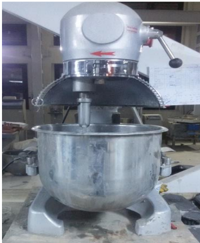
Resim 3.3. 20 litre kapasiteli harç mikserinde YPLDÇK üretimi
