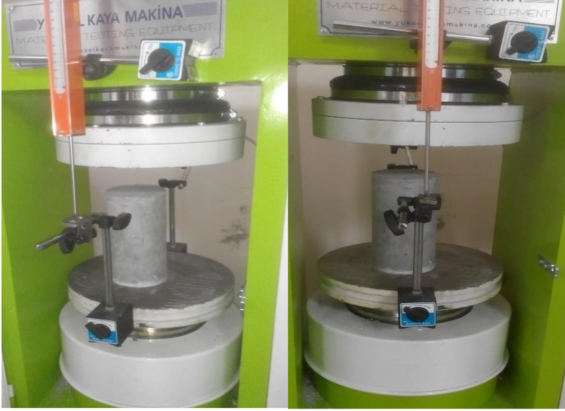
Resim 3.6. Elastisite modülü deney düzeneği
