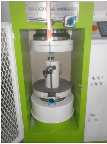
Resim 4.1. Uçucu kül içermeyen YPLDÇK karışımına ait elastisite modülü deneyi
