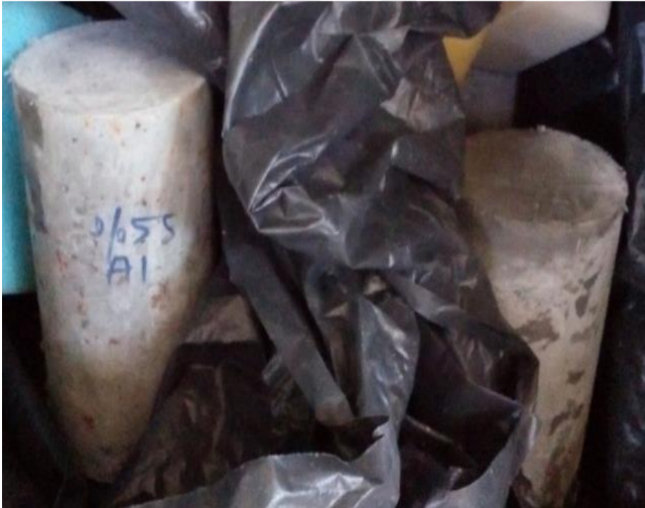
Resim 3.5. Elastisite modülü deneyi numuneleri
