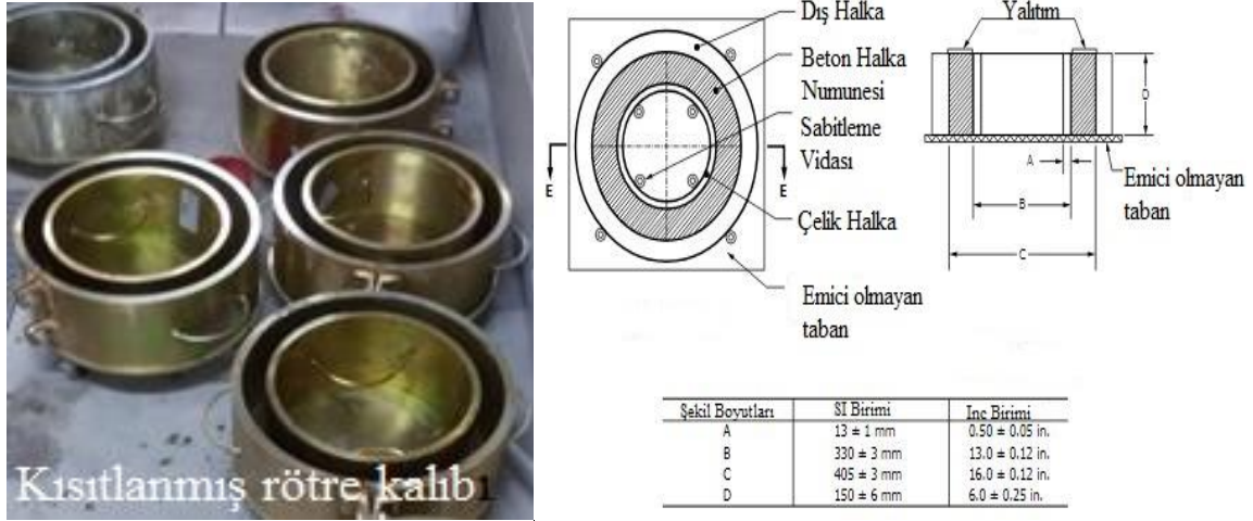
Resim 3.8. YPLDÇK betonu kısıtlanmış rötre deney aleti [98]
