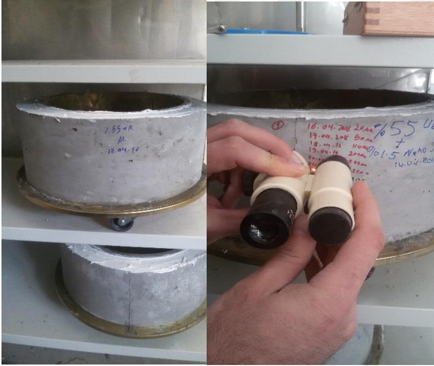
Resim 4.5. Kısıtlanmış rötne deneyi ölçümü
