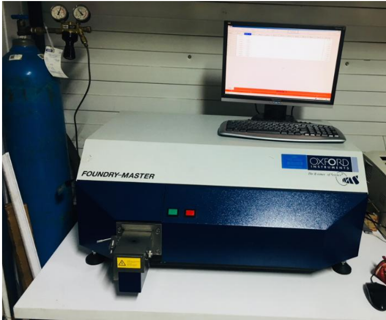
Şekil 3.3. Foundry Master Optik Emisyon Spektrometre
