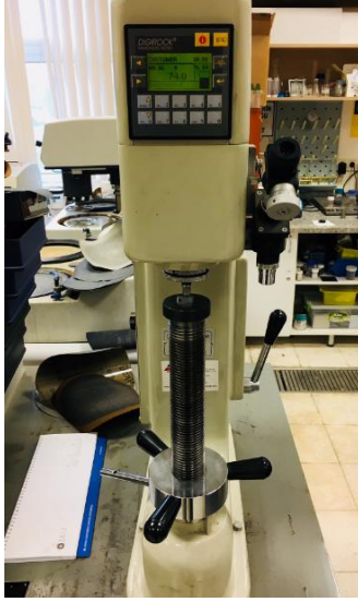
Şekil 3.10. DIGIROCK HARDNESS TESTER marka Brinell sertlik ölçüm cihazı
