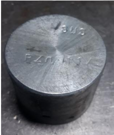
Şekil 3.4. R-Zn11/2 çinko kalibrasyon numunesi
