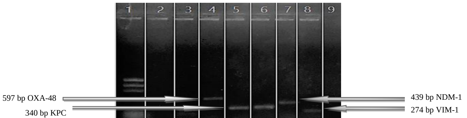
Şekil 27. Klasik PCR Yönteminin jel görüntüsü: Kolon 1: Marker, kolon 2: Negatif kontrol, kolon 3: Pozitif kontrol, kolon 4: bla OXA-48 kontrol, kolon 5: bla KPC kontrol, kolon 6: bla KPC kontrol (tekrar), kolon 7: bla NDM-1 kontrol, kolon 8: bla VIM-1 kontrol
