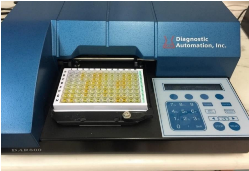
Resim 7. TPO düzeylerinin ölçüldüğü ELISA mikropalak okuyucu.
