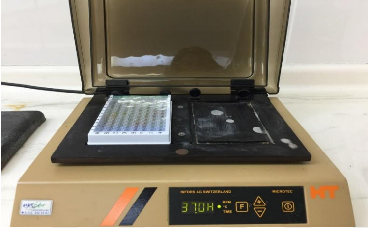
Resim 4. Isıtmalı karıştırıcı içinde plağın enkübasyonu.
