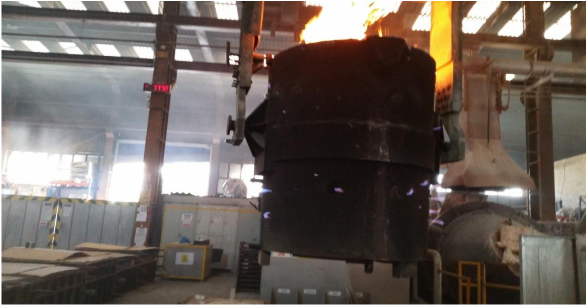
Resim 3-4: Döküm Potasına Eriyik Dökülme İşlemi
