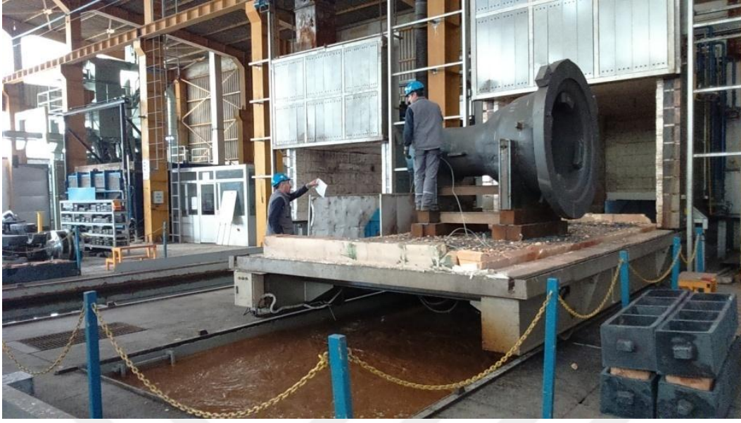
Resim 3-6: Temperleme Hazırlık İşlemi
