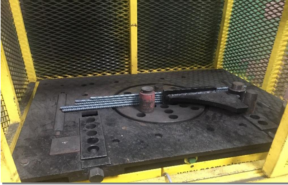
Şekil 3.4. Bükme cihazına bağlı numune
