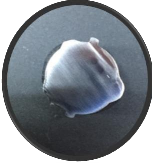
Şekil 4.12 Çubuk no5'in dağlama sonrası makro görüntüsü
