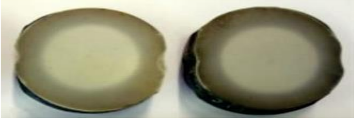
Şekil 1.8. (a) Klasik sistem tempcore sonrası martensit halkası (b) Thermax proses sonrası martensit halkası (Pritam Kumar Rana, 2014)
