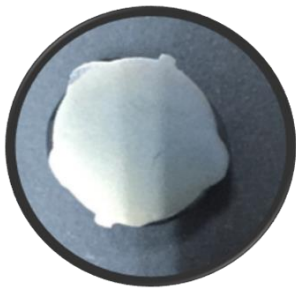
Şekil 4.8 Çubuk no3'ün dağlama sonrası makro görüntüsü
