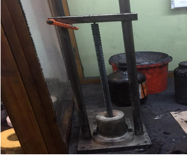
Şekil 3.5. Yorulma numunesi kalıplama kalıbı ve aparatı
