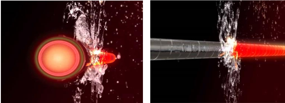
Şekil 1.3. Thermex'te yüzey tabakasına su verme anı (Alberto AUGUSTI, 2013)
