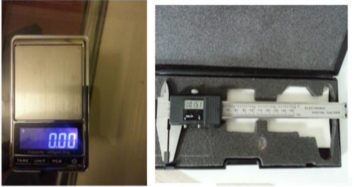
Şekil 3.17 Deneme ve ölçümlerde kullanılan elektronik hassas terazi (0.01 g duyarlılık) ve sayısal kumpas (0.01 mm duyarlılık)
