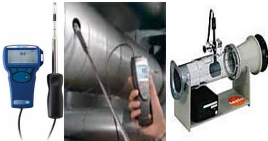
Şekil 3.23 Terminal hız ölçümleri için dijital bir anemometre örnek modeli ve rüzgâr tünellerindeki kullanımları
