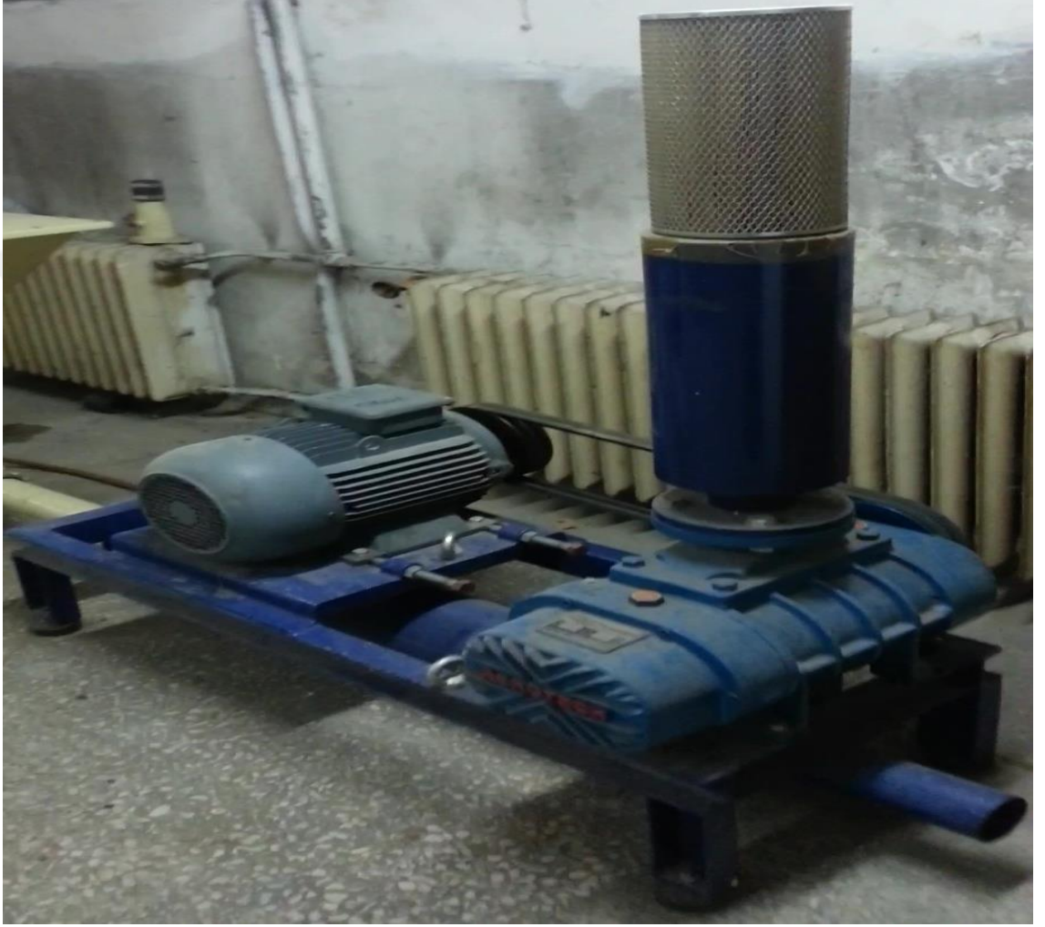
Şekil 3.6 Denemede kullanılan tesiste çalışan roots tipi bir üfleyici (blower)
