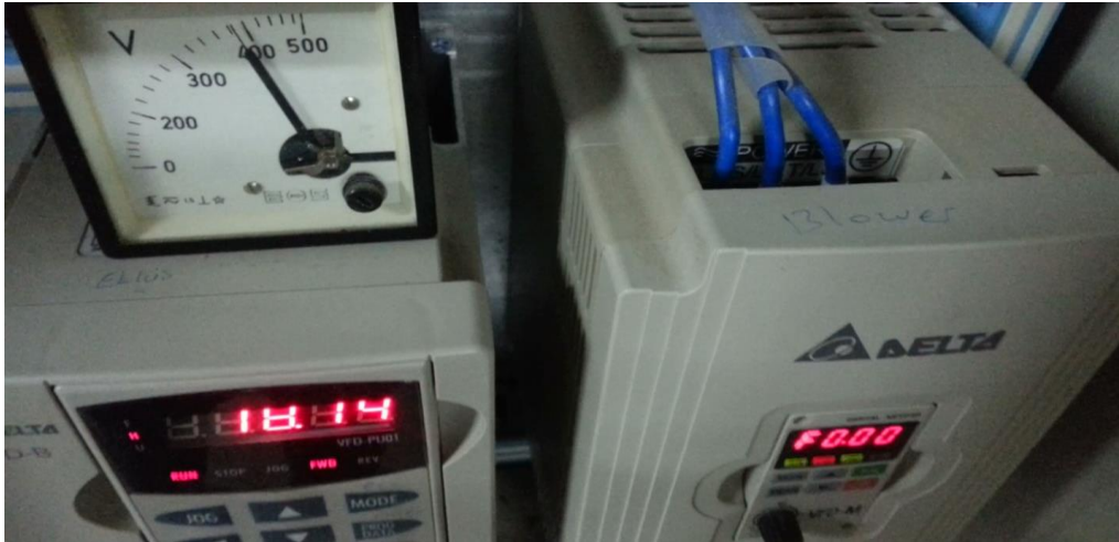
Şekil 3.14 Denemede kullanılan iletim tesisinde roots tipi üfleyici (blower) ile besleyicinin kumanda panelinden ayar ve kumanda cihazları
