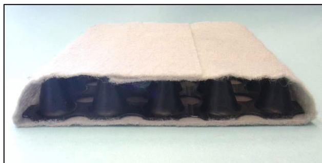
Figure 4.13 Geocomposite Edge Drain
