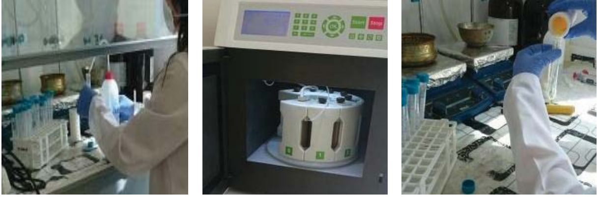
Şekil 2.6. a) Çeker ocak altında örneklerin asit içinde çözdürülmesi, b) Mikrodalga fırınında yakma işlemlerin yapılması
