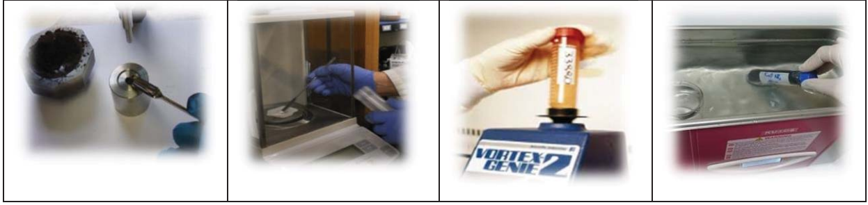
Şekil 2.2. Biyodeneyde kullanılan metal ve metal oksit NP'lerinin stok solüsyonlarının hazırlanma basamakları (Orijinal)
