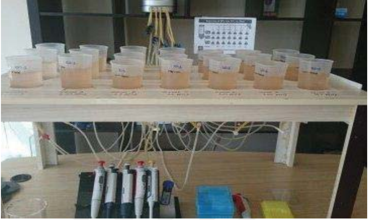
Şekil 2.4. Cu ve CuO NP'lere maruz bırakılan A. salina biyodeneý düzeneđi (orijinal)
