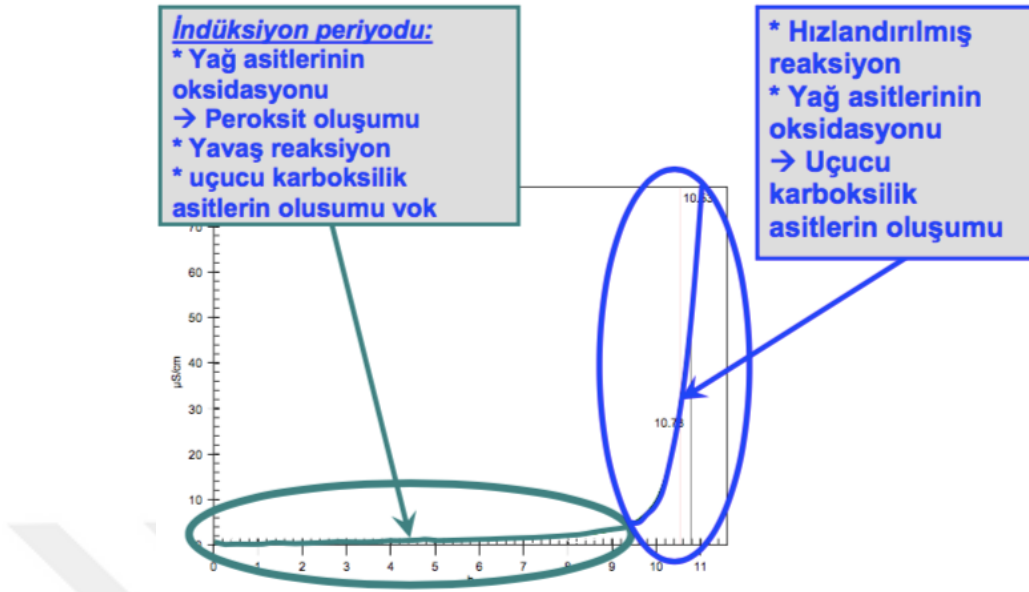
Şekil 2.5. Oksidatif tepkimelerin zamanın fonksiyonu olarak gelişimi [40]
