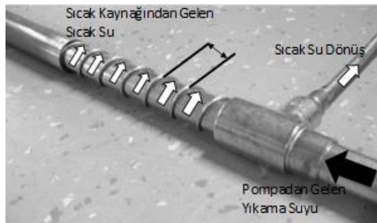
Şekil 2. 21 Sıcak suyun ısısının kullanıldığı ısı değiştiricisi [12]
