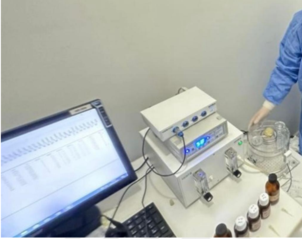
Şekil 3.2: Tüm vücut pletizmograf ile solunum fonksiyon testi ile Penh skorlarının ölçülmesi
