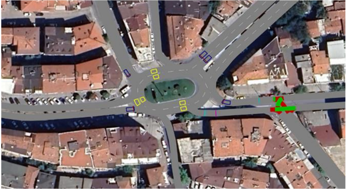
Şekil 5. 8: PTV Vissim Öneri 1 modellemesi dedektör yerleşimi.
