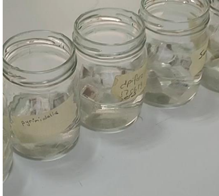
Şekil 3.15. Paketlenen tohumların % 35 lik \text{NaOCl} 'de bekletilmesi
