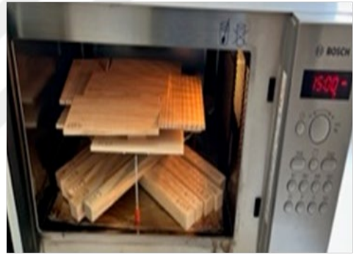
Şekil 3.4. Mikrodalga kurutma cihazı görselleri
