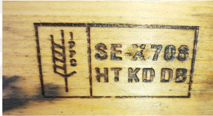
Şekil 2.28. İkinci el palet üzerine yapılmış ISPM 15 izlenirlik işareti örneği
