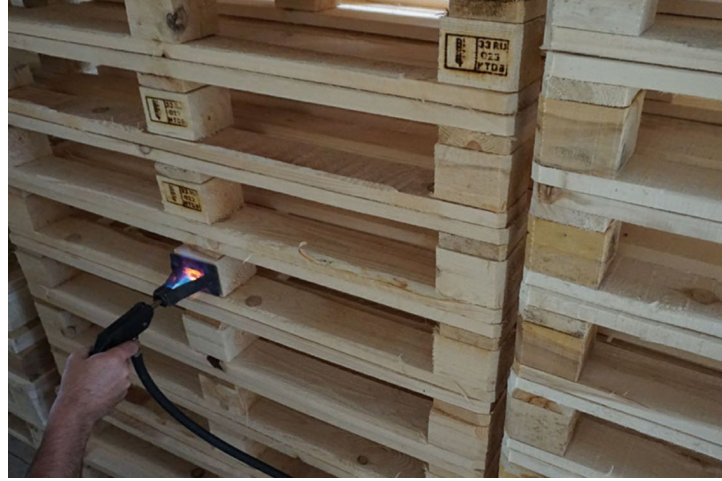
Şekil 2.27. Birinci el palet üzerine yapılan ISPM 15 izlenirlik işareti örneği
