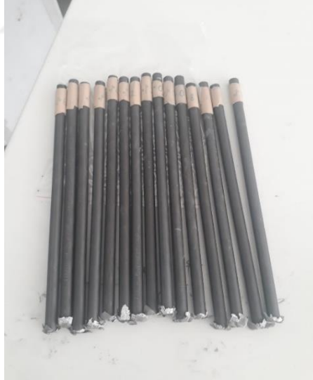
Şekil 4.13. İnfiltrasyonda kullanılan çelik borular
