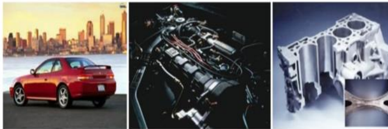
Şekil 3.6. Alüminyum esaslı metal matrisli kompozit malzeme kullanılarak üretilmiş Honda marka aracın motor bloğu [17]
