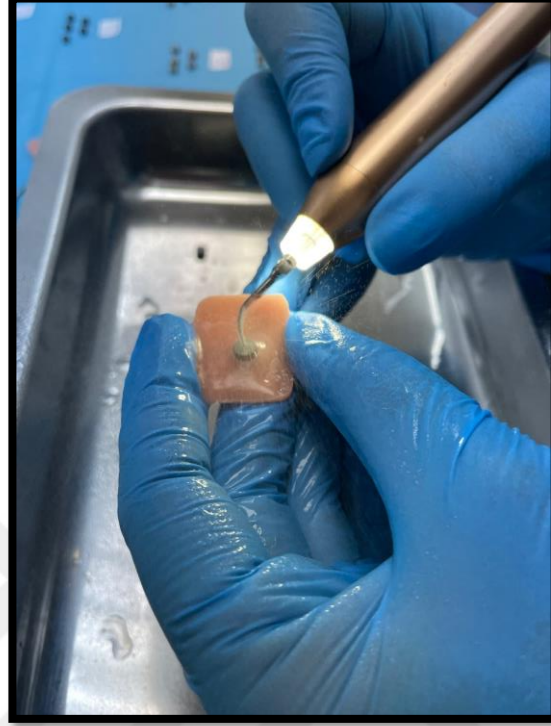
Resim 19. Çelik ucun titanyum disk yüzeyine uygulanması
