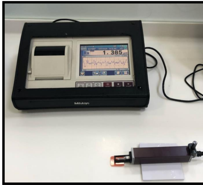
Resim 15. Titanyum disklerin yüzey pürüzlülüğünün profilometre cihazı ile ölçülmesi
