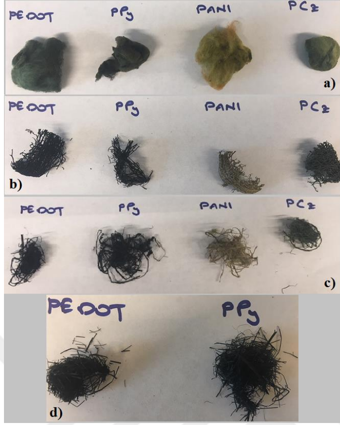
Şekil 4.1 : Bazı DL/İP iletken kompozit liflerinin görünümü, a) PL/PEDOT – PL/PPy – PL/PANi – PL/PCz, b) LL/PEDOT – LL/PPy – LL/PANi – LL/PCz, c) EL/PEDOT – EL/PPy – EL/PANi – EL/PCz ve d) ML/PEDOT – ML/PPy.
