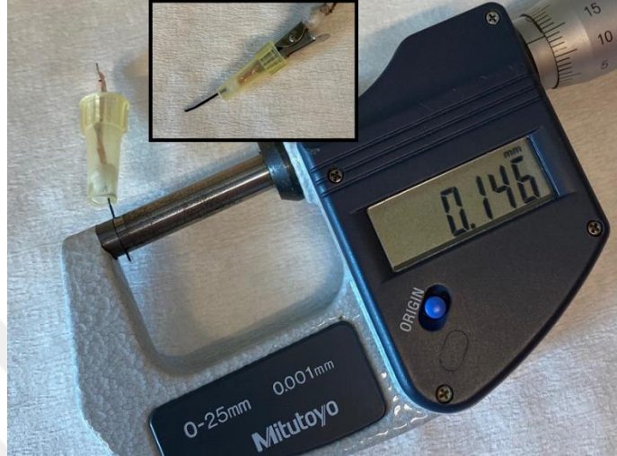
řekil 3.7 : Dijital mikrometre ve mikroskop ile ölçülen lif örneęi.
