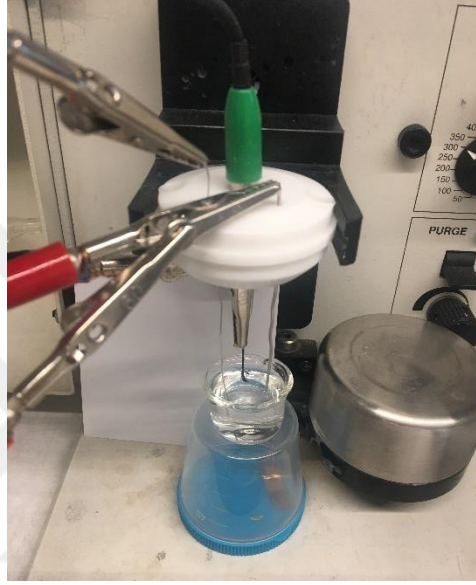
Şekil 3.9 : Üçlü elektrot hücresinin hazırlanışı.
