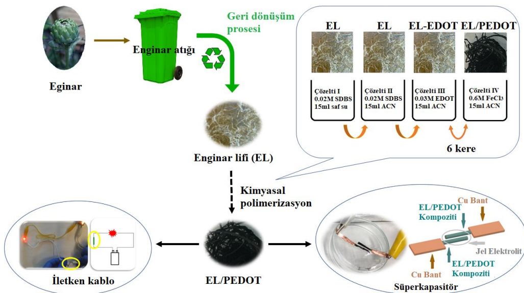
Şekil 3.5 : EL/PEDOT iletken kompozitinin ve uygulamasının hazırlanışının akış şeması.
