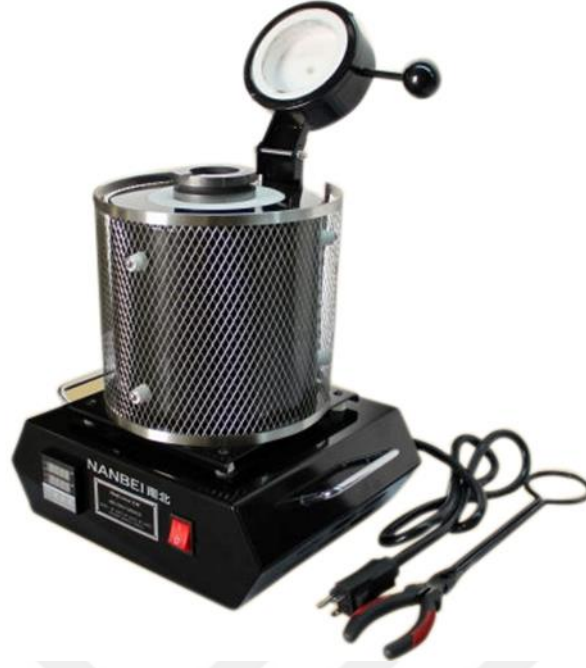
Şekil 5.1 : MF-1000 model elektrikli ergitme fırını.
