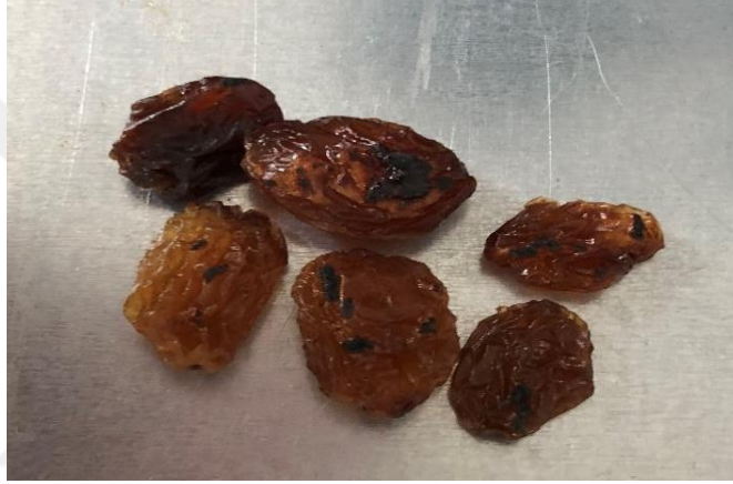
Şekil 4.1 2000 Hz frekansta DBD plazma işleminin hareketsiz yapılması sonucu kuru üzümde oluşan bölgesel yanıklar.
