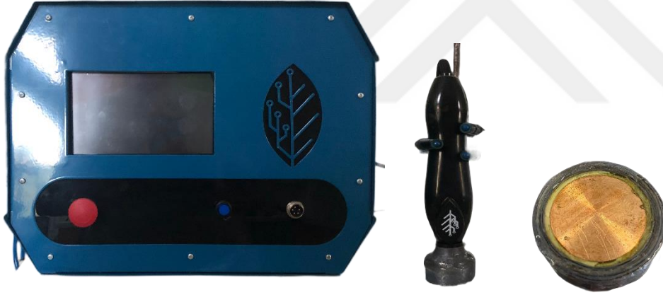
Şekil 3.1 Dielektrik bariyer deşarj plazma ve elektrotu.
