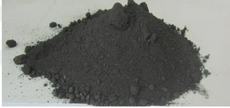
Fotoğraf 3.12. 10 10 05* atık kodlu henüz döküm yapılamamış tehlikeli madde içeren maça ve kum döküm kalıpları
