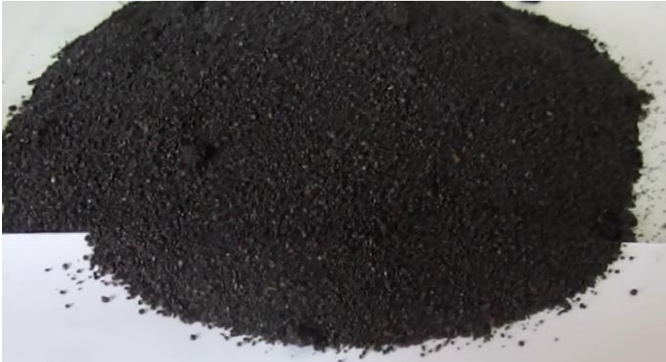
Fotoğraf 3.13. 10 10 07* atık kodlu döküm yapılmamış tehlikeli madde içeren maça ve kum döküm kalıpları
