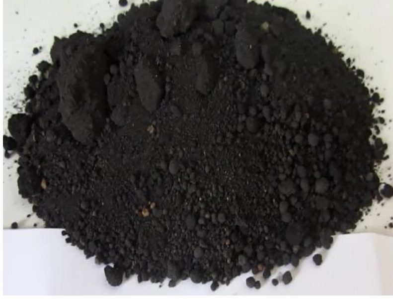
Fotoğraf 3.9. 10 09 07* atık kodlu döküm yapılmış tehlikeli madde içeren maça ve kum döküm kalıpları
