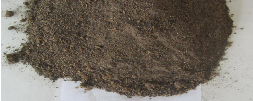
Fotoğraf 3.3. 10 01 03 atık kodlu turba ve işlenmemiş odundan kaynaklanan uçucu kül
