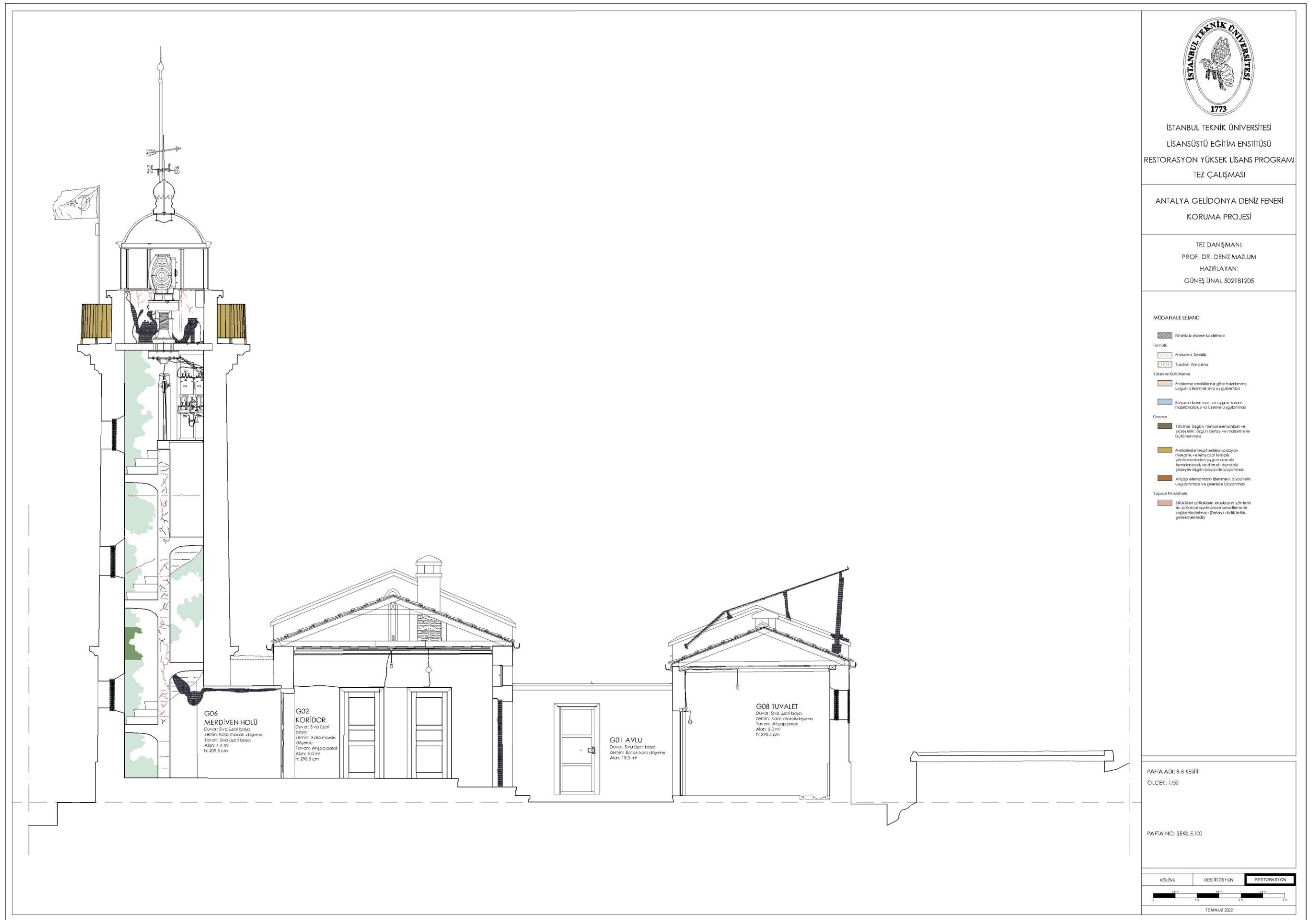
Şekil E. 100 : Restorasyon: B-B kesiti müdahale analizi .
