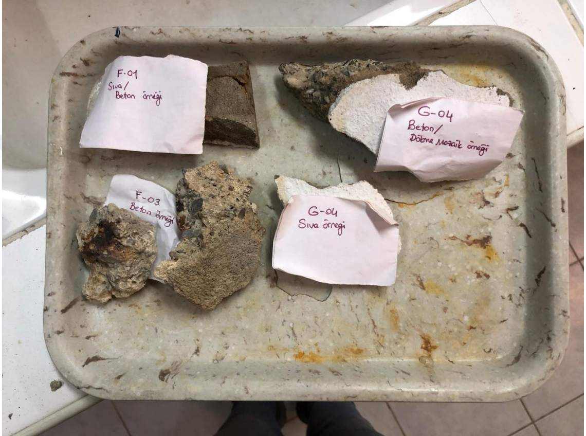
Şekil 4. 15 : Yapıdan alınan sıva ve beton örnekleri.
