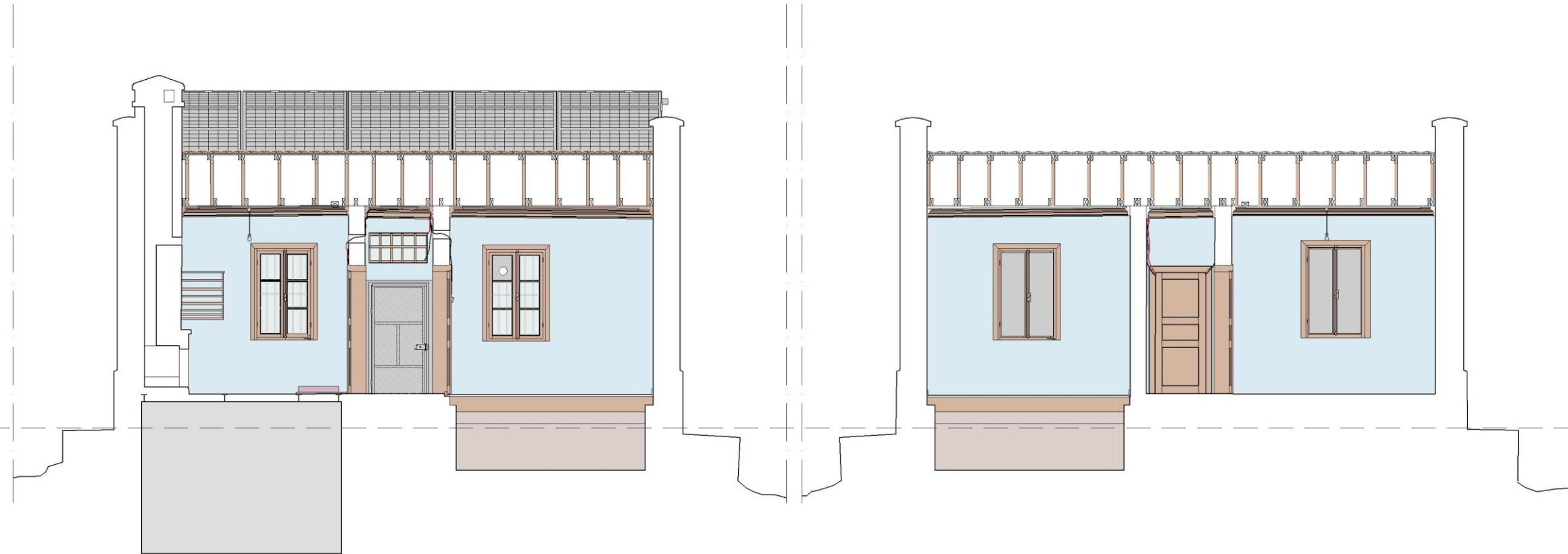
Şekil E. 35 : Rölöve: I-I ve J-J kesitleri malzeme analizi.
