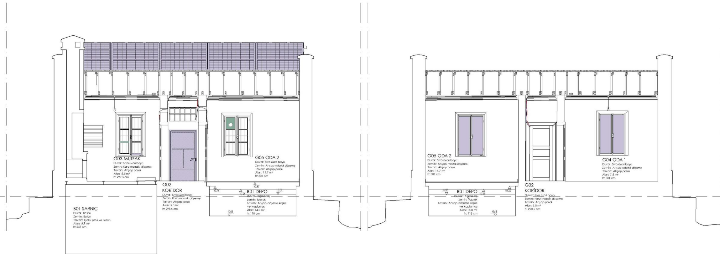
Şekil E. 50 : Rölöve: I-I ve J-J kesitleri bozulma analizi.
