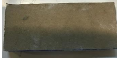
Şekil 7.15 : Kartonlu alçı levhada, büyümenin ilk aşaması (indeks 2) bir hafta maruz (96% RH ve 22°C)kaldıktan sonra. (Mikroskop altında ve çıplak gözle değerlendirilmesi).
