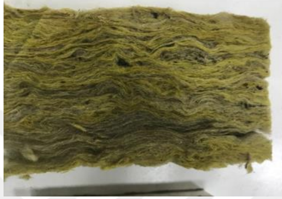
Şekil 7.17 : Taş yününde 2. ve 9.hafta değişimler .
