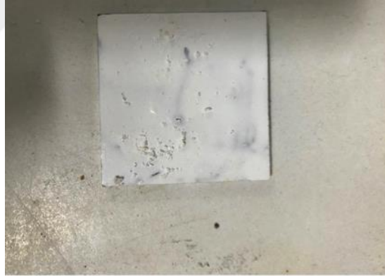
Şekil 7.17 : Taş yününde 2. ve 9.hafta değişimler .
