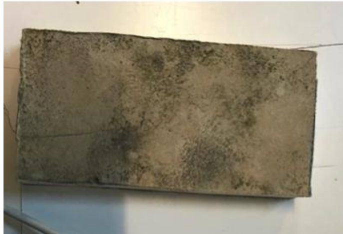
Şekil 7.16 : Kartonlu alçı levha da, indeks 3 (ilk görsel bulgular) testin başlangıcından 2 hafta sonra tespit edildi.
