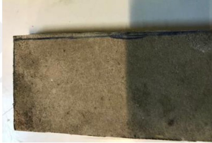
Şekil 7.15 : Kartonlu alçı levhada, büyümenin ilk aşaması (indeks 2) bir hafta maruz (96% RH ve 22°C)kaldıktan sonra. (Mikroskop altında ve çıplak gözle değerlendirilmesi).
