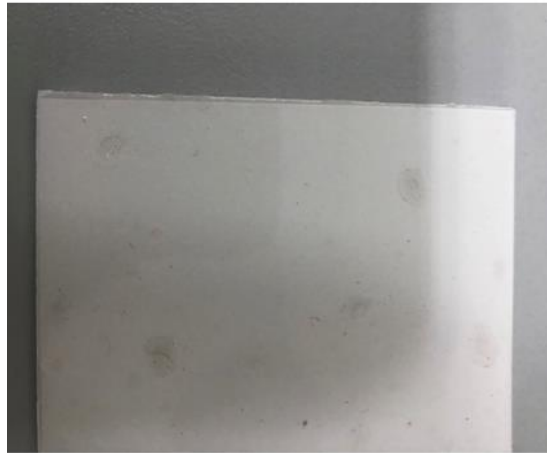
Şekil 7.18 : Su bazlı ve solvent bazlı boyalar üzerinde mantar büyümesi 8-10 hafta arasında çıplak gözle görülecek şekilde belirlendi .
