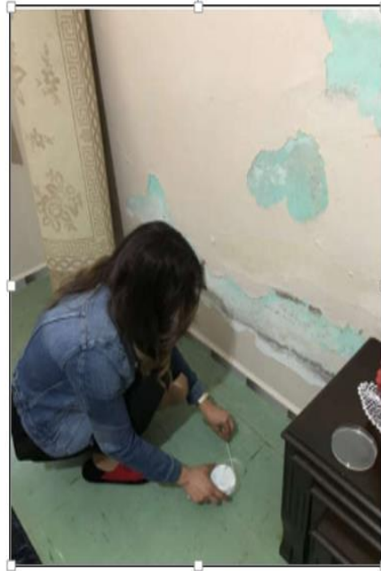
Şekil 7.1 : Petri kabının dibinde pamuklu çubuğunu ileri ve geri kaydırarak küf numunesinin dikkatlice petri kabına aktarılması.
