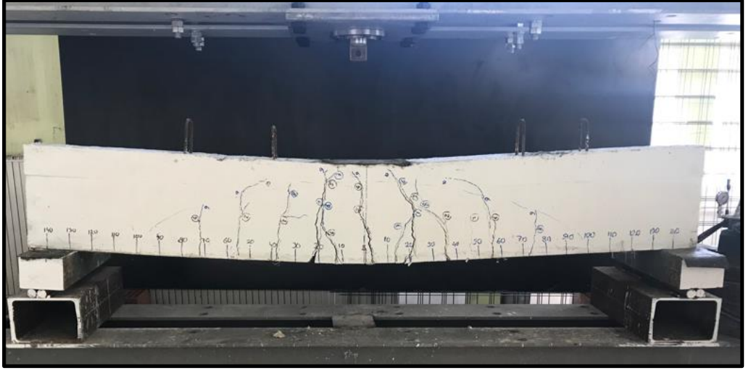
Şekil 3.16. K3 kirişinin (referans) göçme şekli
