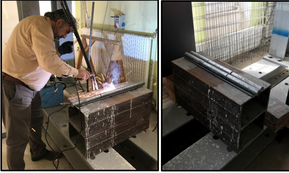
Şekil 2.49. Sabit ve hareketli mesnetlerin oluşturulması
