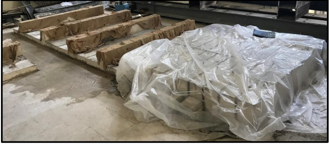
Şekil 2.41. Deney numunelerine kür uygulanması (1/2 ölçekli deney)
