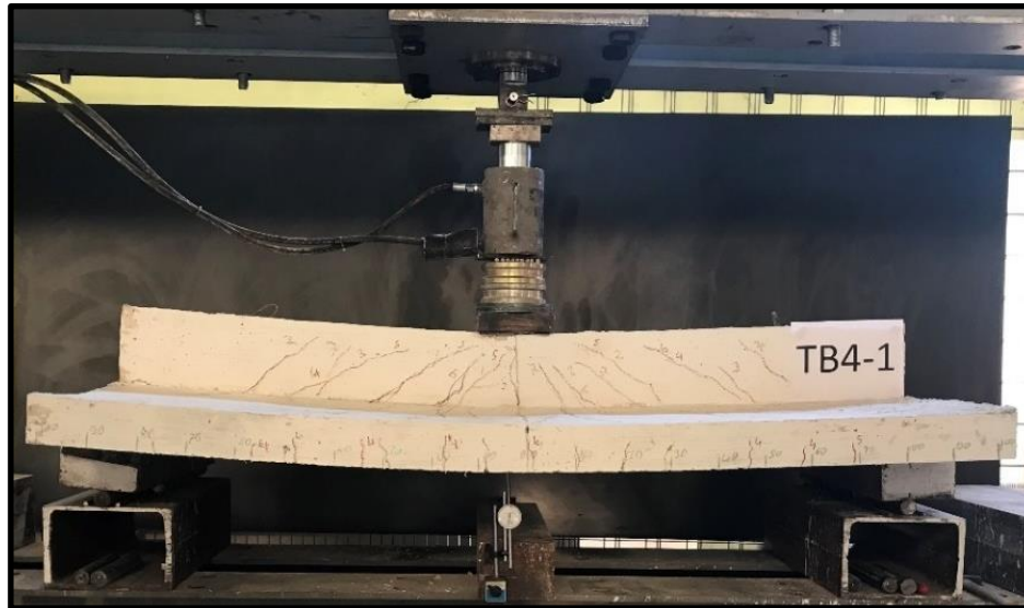
Şekil 3.36. TB4-1 kirişinin çatlak dağılımı ve göçme şekli
