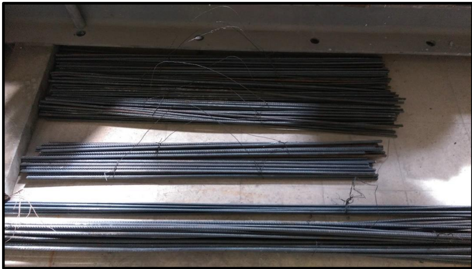
Şekil 2.25. Kesilen donatıların ölçülerine göre ayrılması (1/1 ölçekli deney)
