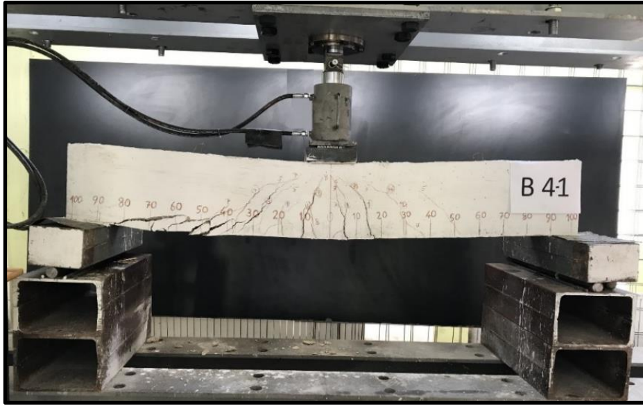
řekil 3.54. B4-1 kiriřinin atlak daėılımı ve gme řekli
