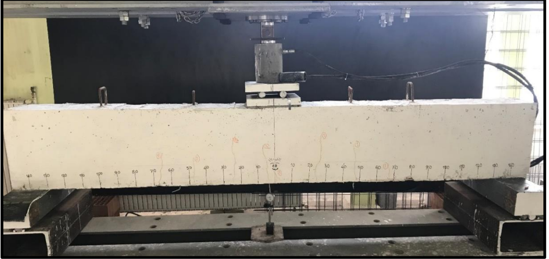
Şekil 3.9. K2 kirişinde oluşan ilk çatlaklar
