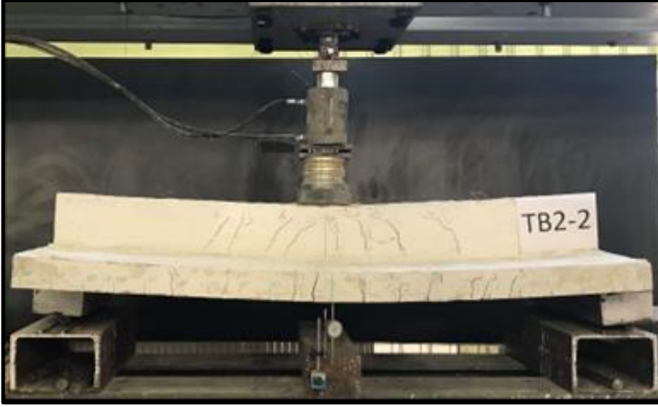
Şekil 3.29. TB2-2 kirişinin çatlak dağılımı ve göçme şekli
