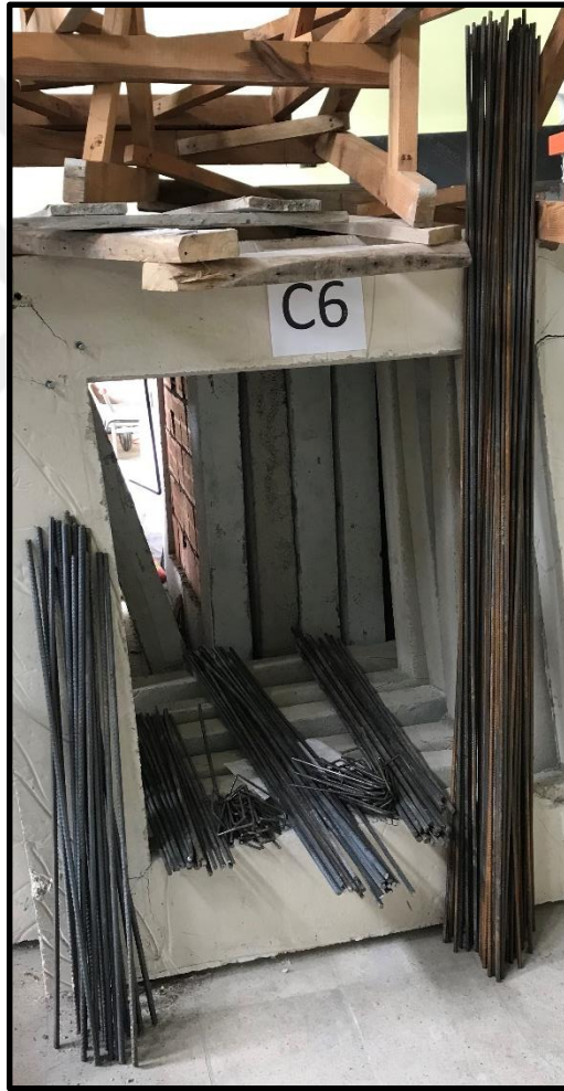
Şekil 2.35. Kesilen donatıların ölçülerine göre ayrılması (1/2 ölçekli deney)
