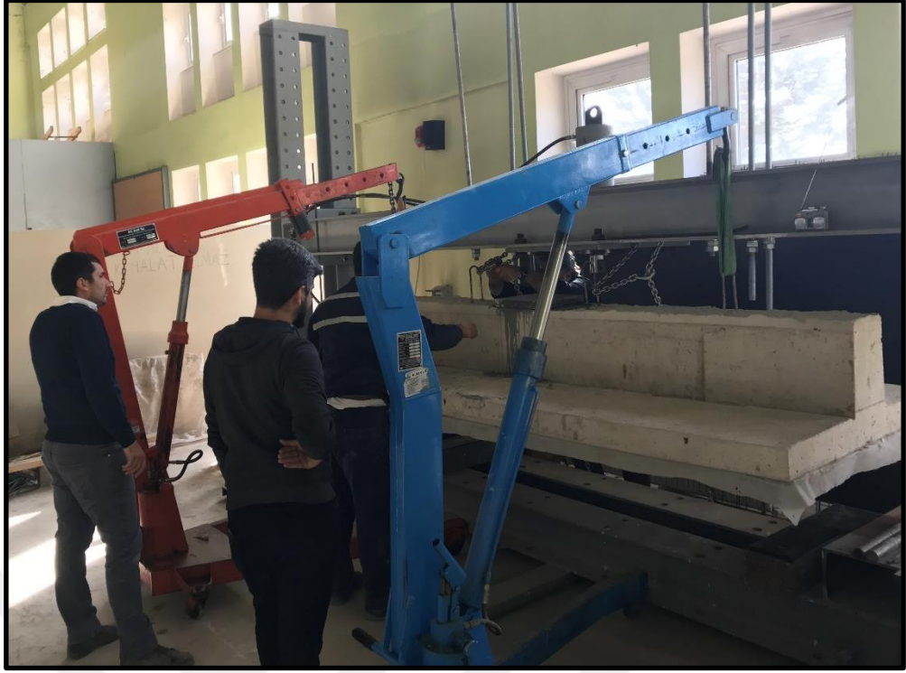
Şekil 2.51. Deney numunelerinin yükleme çerçevesine alınması
