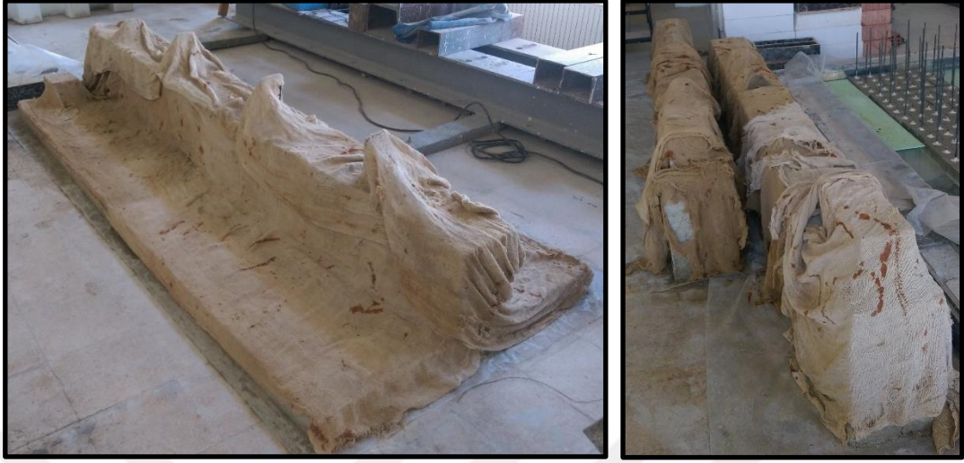
řekil 2.32. Deney numunelerine kr uygulanması (1/1 lekli deney)
