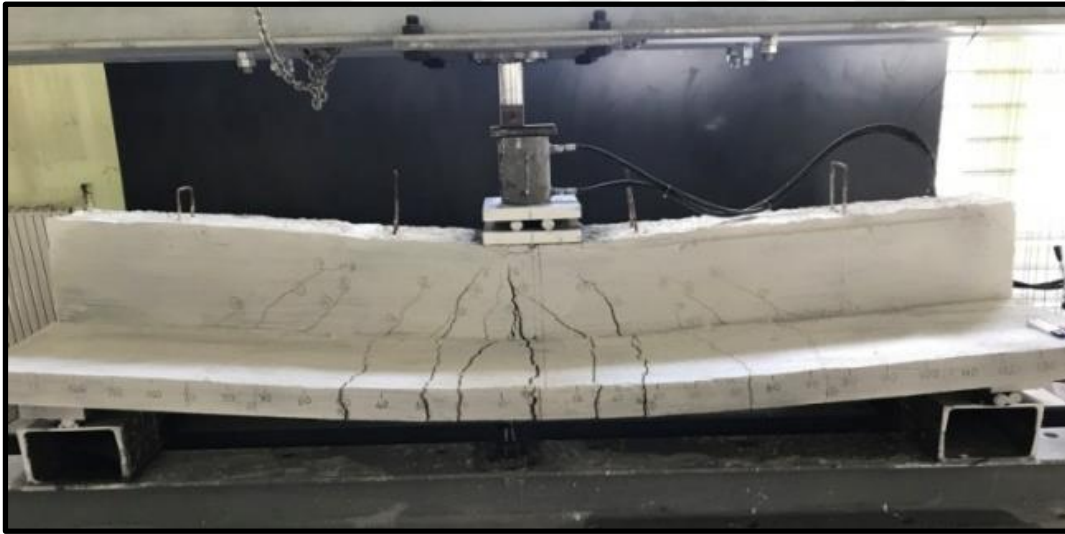
Şekil 3.7. TK1 kirişinin (tablalı) göçme şekli
