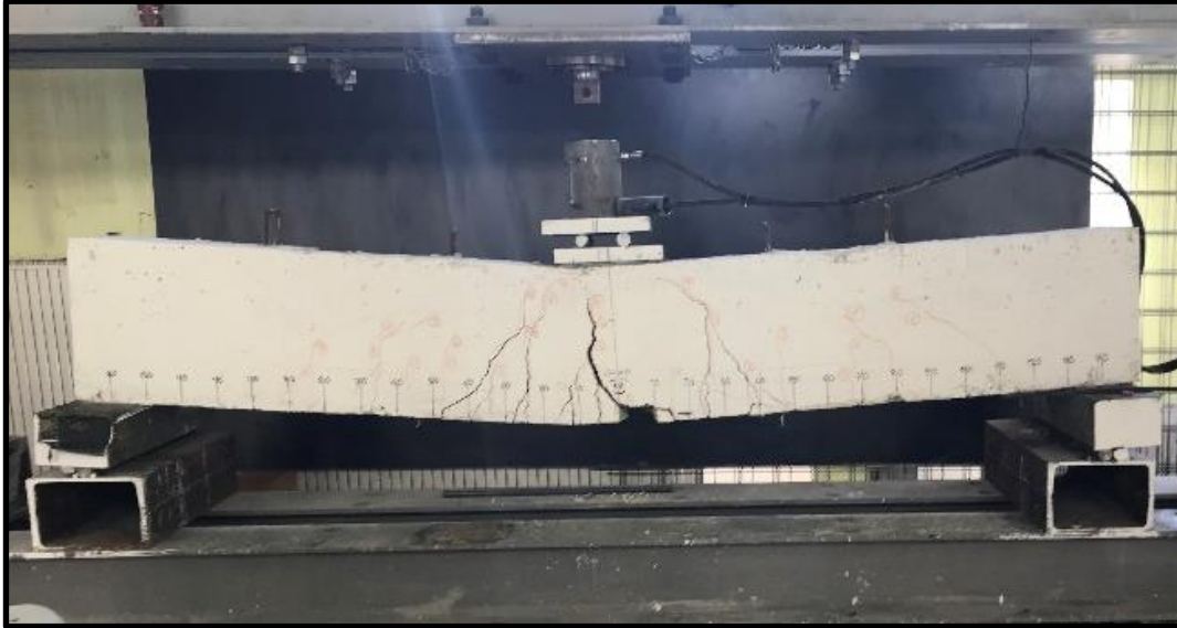
Şekil 3.11. K2 kirişinin (döşeme donatılı) göçme şekli
