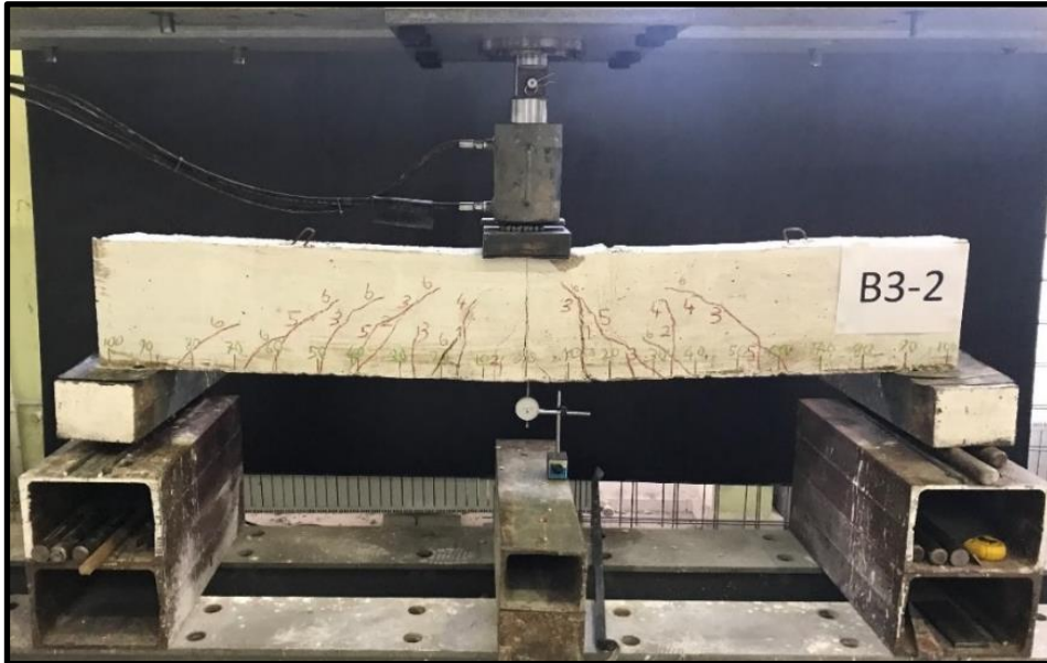
Şekil 3.51. B3-2 kirişinin çatlak dağılımı ve göçme şekli
