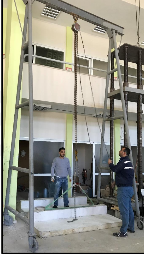
Şekil 2.45. Portal vinç ve caraskal (hareketli palanga)
