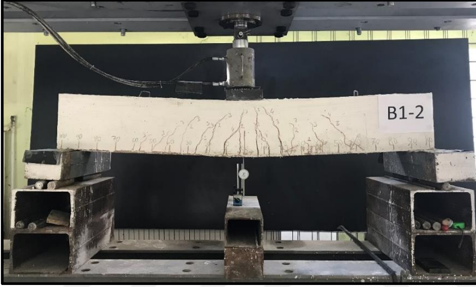
Şekil 3.42. B1-2 kirişinin çatlak dağılımı ve göçme şekli
