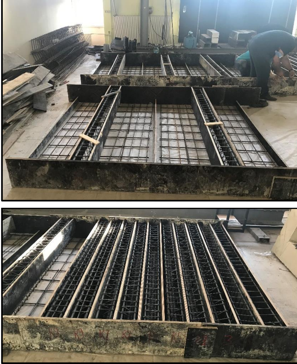
Şekil 2.38. Deney numunelerinin beton dökümüne hazır hale getirilmesi-1 (1/2 ölçekli deney)
