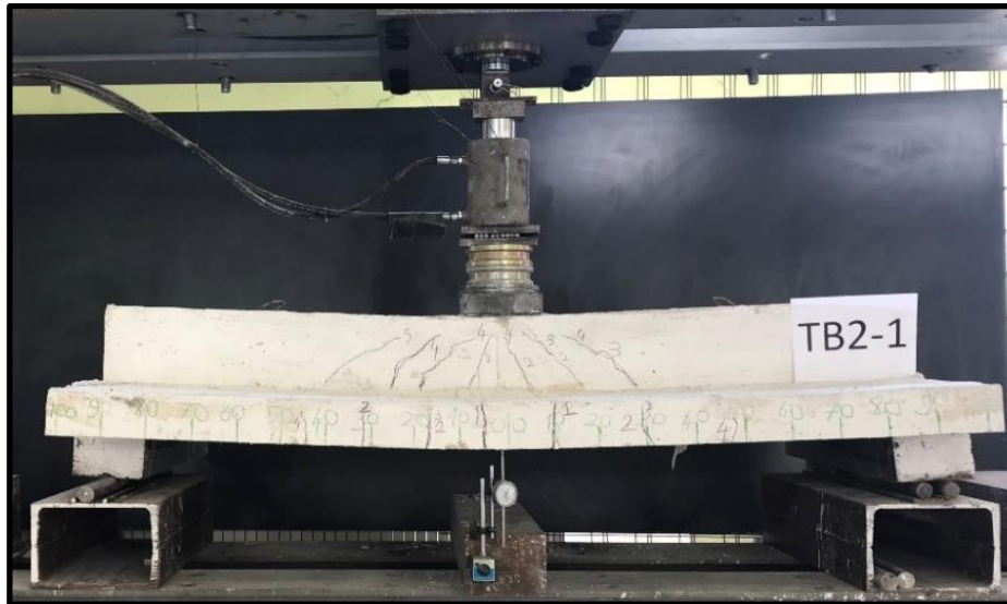
Şekil 3.28. TB2-1 kirişinin çatlak dağılımı ve göçme şekli
