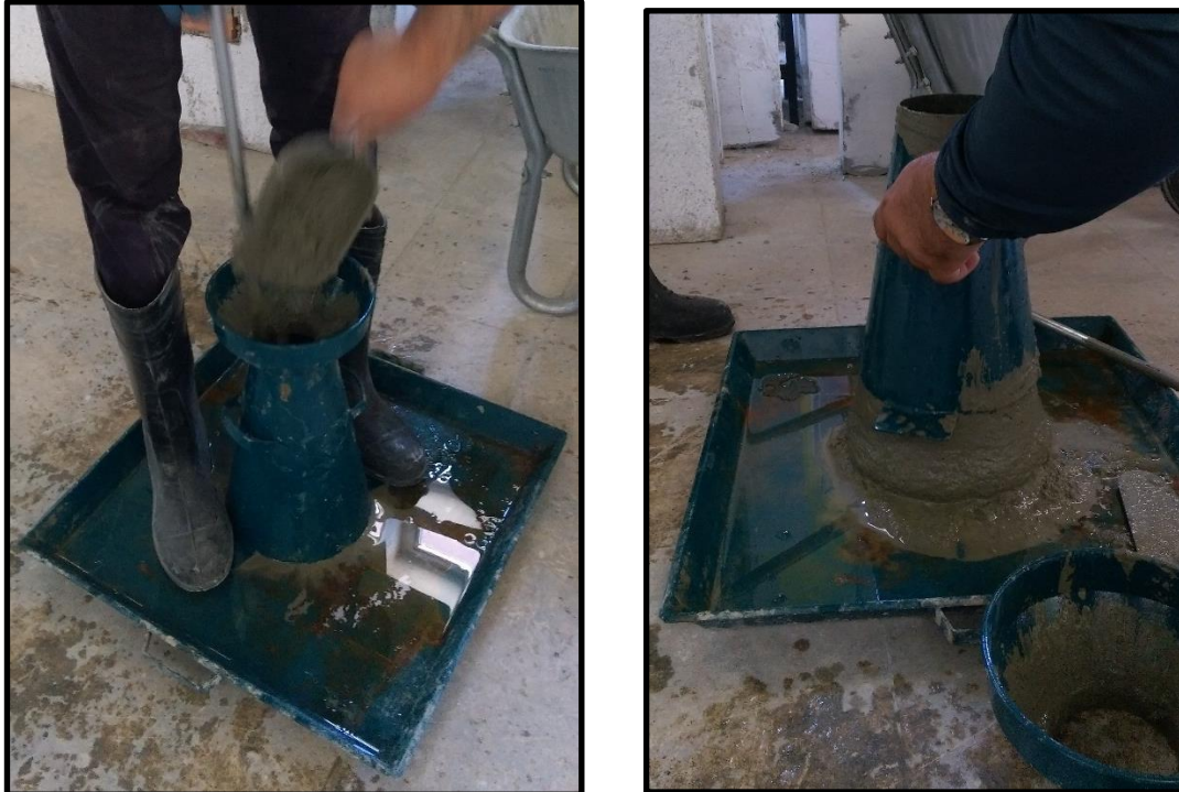
Şekil 2.21. 1/2 ölçekli deneyde çökme (slump) deneyi
