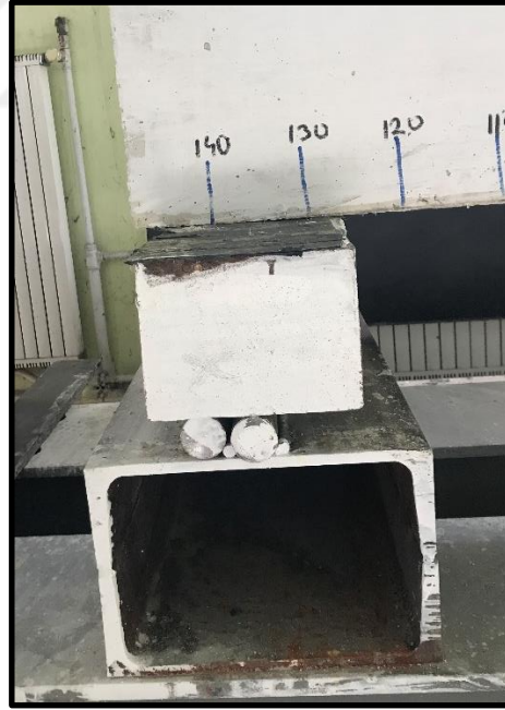
Şekil 2.50. Kiriş numunesi ile mesnetteki kutu profil arasına elastomer kauçuk yerleştirilmesi
