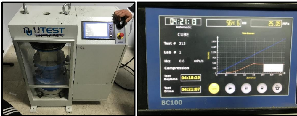
Şekil 2.20. Tek eksenli basınç dayanım deneyi
