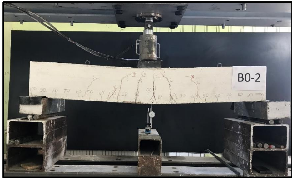
Şekil 3.20. B0-2 kirişinin çatlak dağılımı ve göçme şekli
