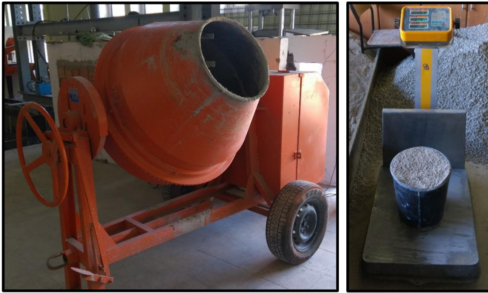
Şekil 2.17. Beton karışımının hazırlanması
