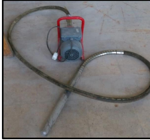
Şekil 2.30. Deneyde kullanılan dalıcı vibratör
