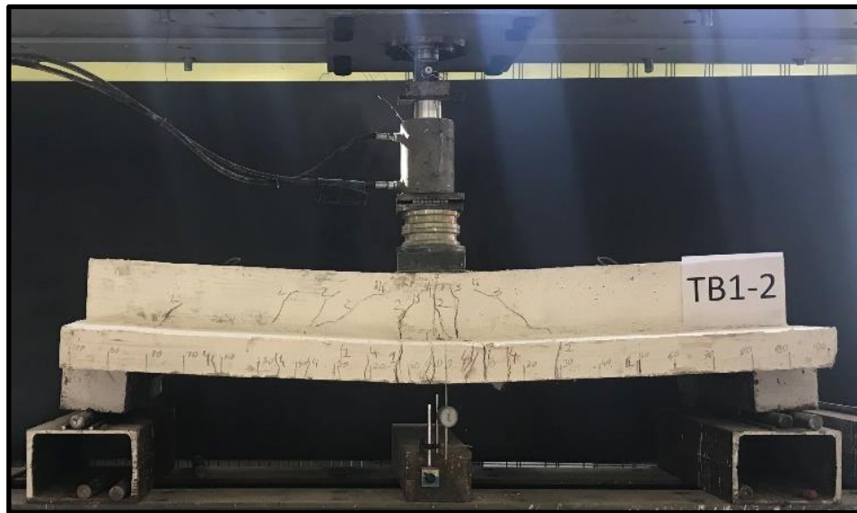
Şekil 3.24. TB1-2 kirişinin çatlak dağılımı ve göçme şekli
