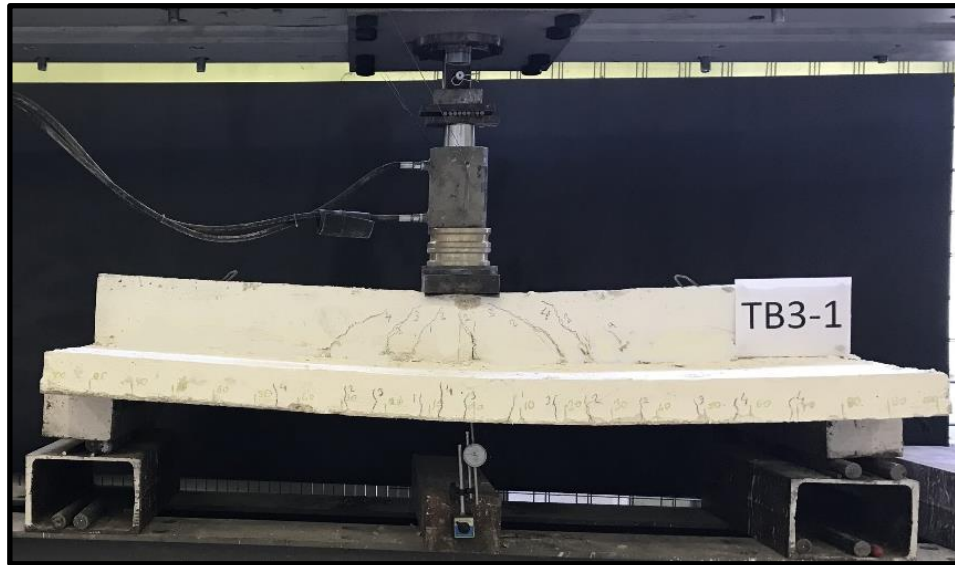
Şekil 3.32. TB3-1 kirişinin çatlak dağılımı ve göçme şekli
