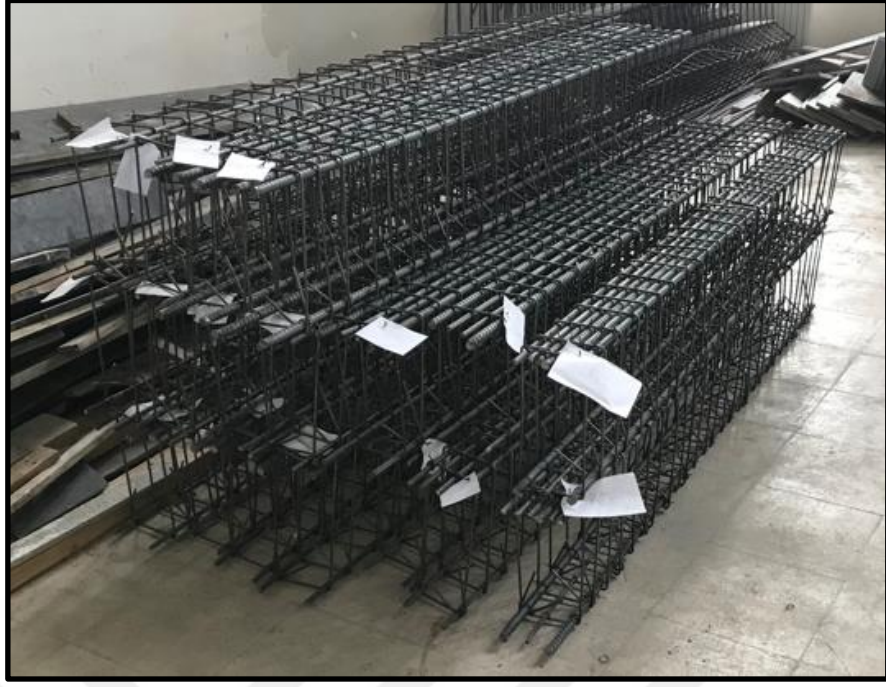
Şekil 2.36. Kiriş donatı kafeslerinin hazırlanması (1/2 ölçekli deney)
