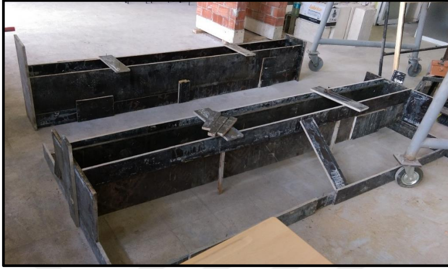
Şekil 2.28. Deney numunelerinin kalıbının hazırlanması (1/1 ölçekli deney)
