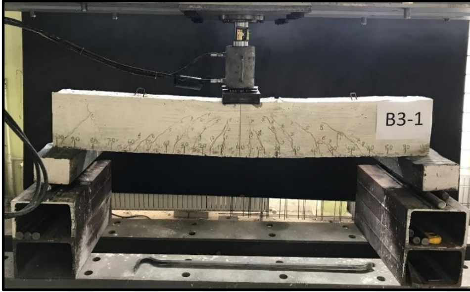
Şekil 3.50. B3-1 kirişinin çatlak dağılımı ve göçme şekli
