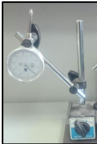
Şekil 2.44. Manyetik ayaklı mekanik komperatör saati
