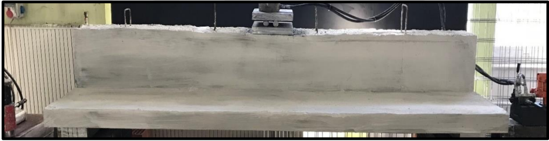
řekil 2.33. Deney numunelerinin beyaz kirece boyanması (1/1 lekli deney)
