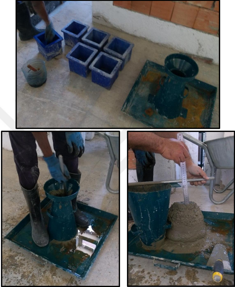
Şekil 2.18. 1/1 ölçekli deneyde çökme (slump) deneyi
