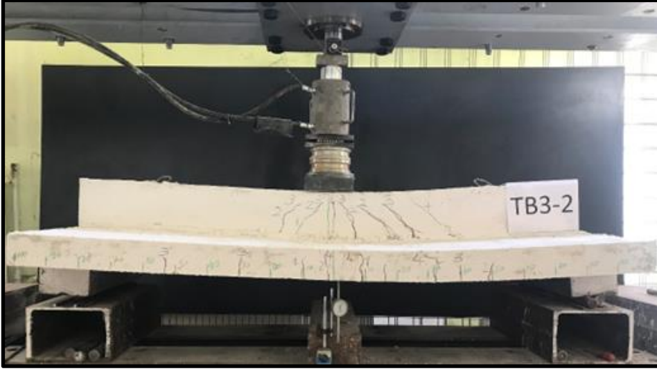
Şekil 3.33. TB3-2 kirişinin çatlak dağılımı ve göçme şekli
