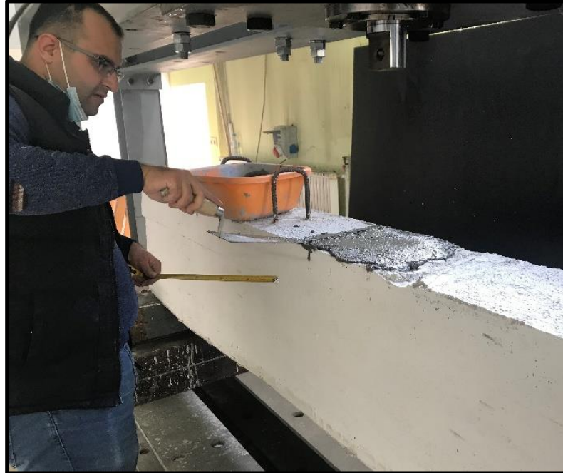
Şekil 2.52. Numune ile noktasal yük levhası arasındaki pürüzlerin giderilmesi
