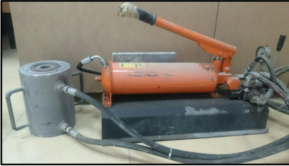
Şekil 2.43. El kontrollü hidrolik kriko
