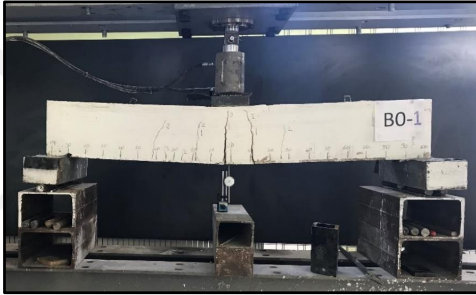
Şekil 3.19. B0-1 kirişinin çatlak dağılımı ve göçme şekli
