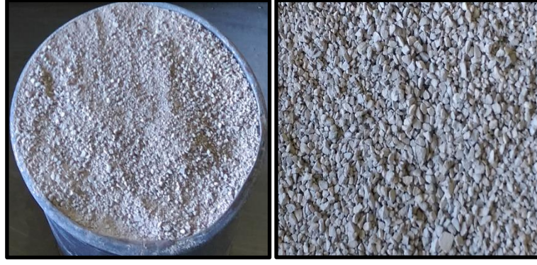
Şekil 2.13. İnce ve iri agregaların görünümü
