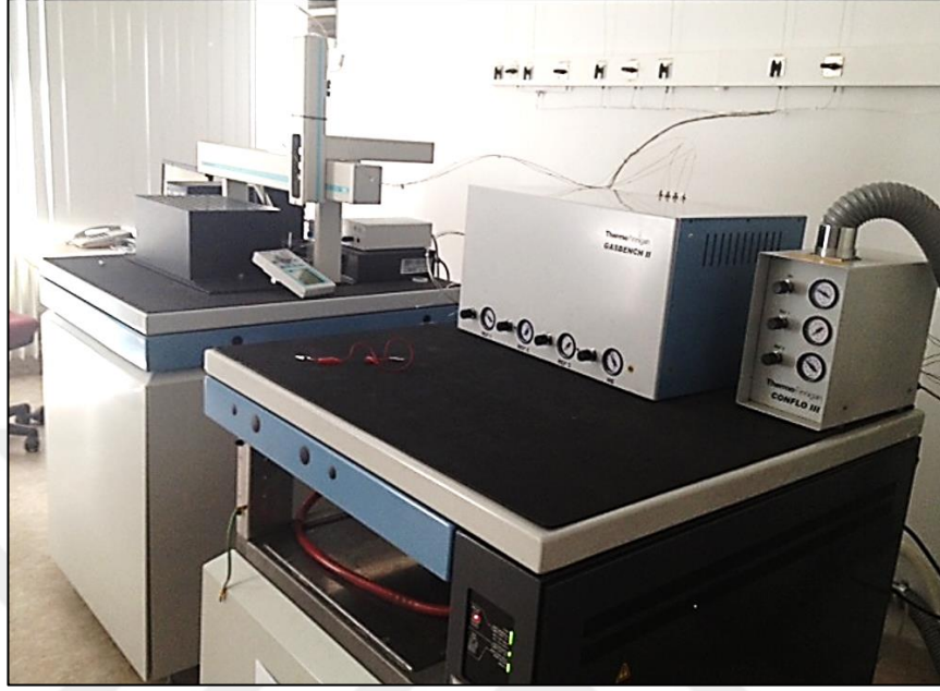
Şekil 5.12 ODTÜ Merkez Laboratuvarı'nda Bulunan İzotop Oranı Kütle Spektrometresi (IRMS) Cihazı
