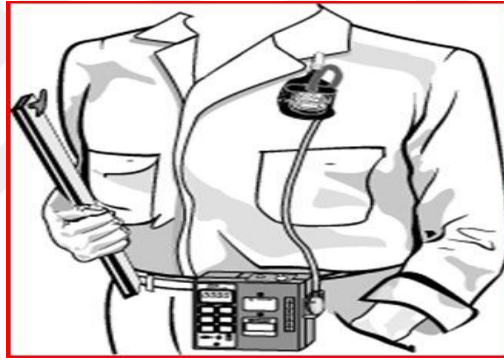
Şekil 3.9: Toz maruziyet cihazının vücuda yerleştirilme görseli
