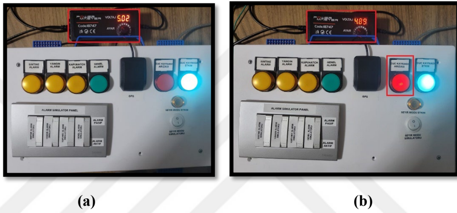
Şekil 4.5. Sistemin gerilim durumu bilgi kısmı; a) Sistem gerilimi 5 V üzeri iken arıza lambası sönmüş; b) Sistem gerilimi 5 V altına düşüncü aktif olan arıza lambası (Alarmın geldiği gerilim değeri 4.89 V)
