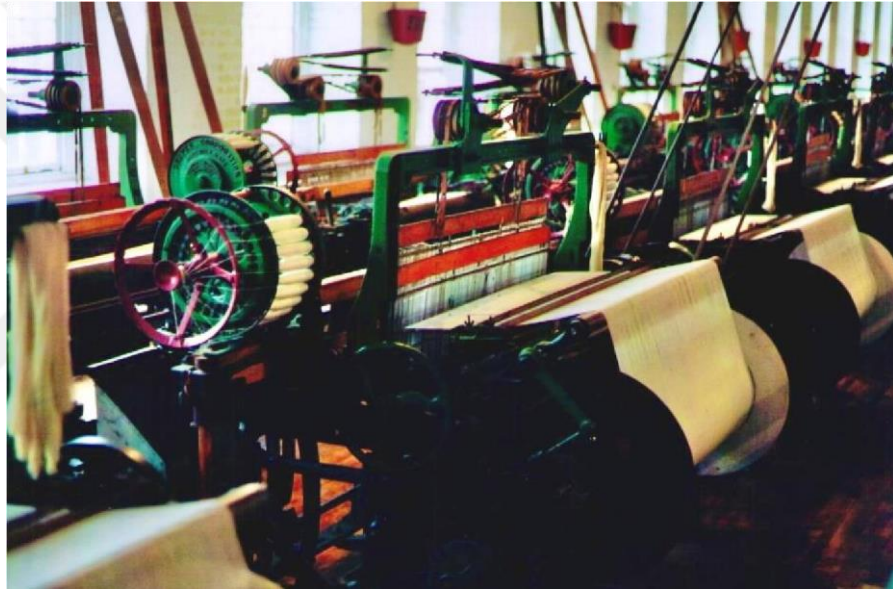
Resim 2.5. Su Gücü İle Çalışan Dokuma Makinesi ‘Power Loom’. 5
