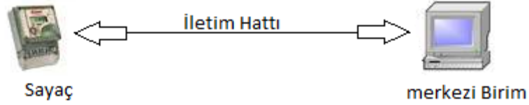
Şekil 2.22. OSOS için iletim hattı durumu
