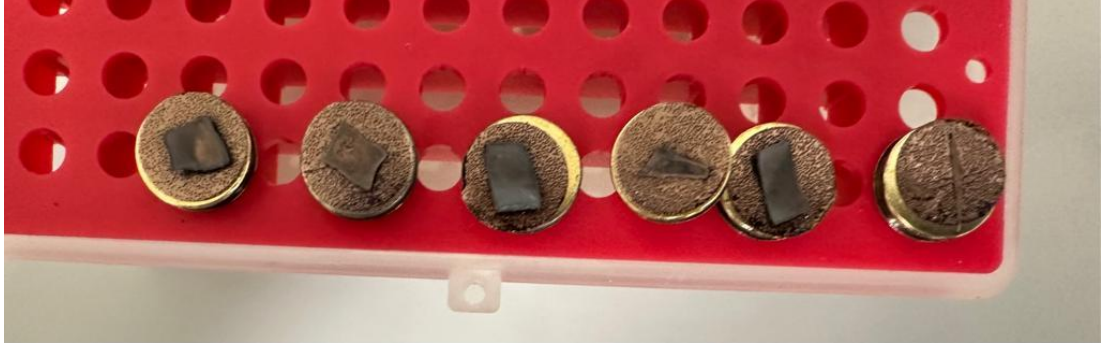
Şekil 4. 9 Hazırlanan hidrojel filmlerin yüzeyinin altın ile kaplanması
