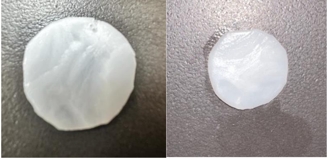
Şekil 4. 4 Oluşturulan PVA hidrojel filmlerin görüntüsü
