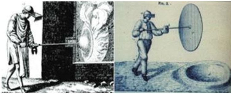
Şekil 2. 4 : Camın balon şeklinde üflenmesi (solda), Üfleme tekniğinde camın düzleştirilmesi (sağda).
