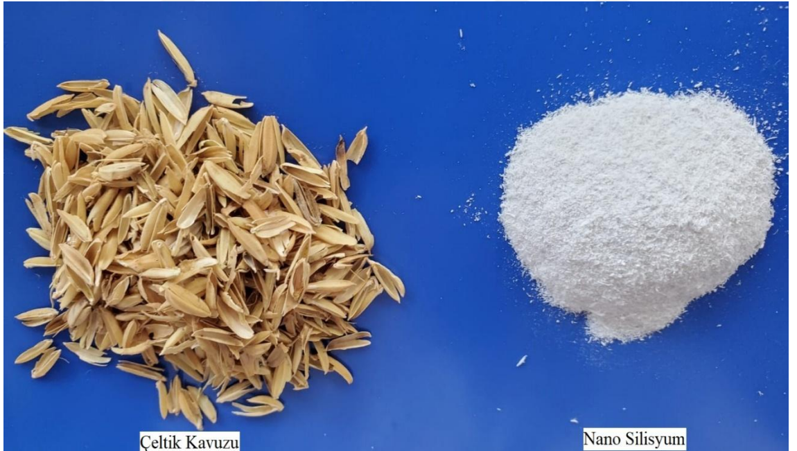
Şekil 3.1 Çeltik kavuzu ve çeltik kavuzundan elde edilmiş Nano-Si
