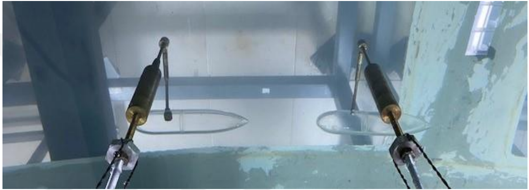
Şekil 3.14. Eliptik burun yapısına sahip iki torpido benzeri geometrinin deneysel konumlandırılması
