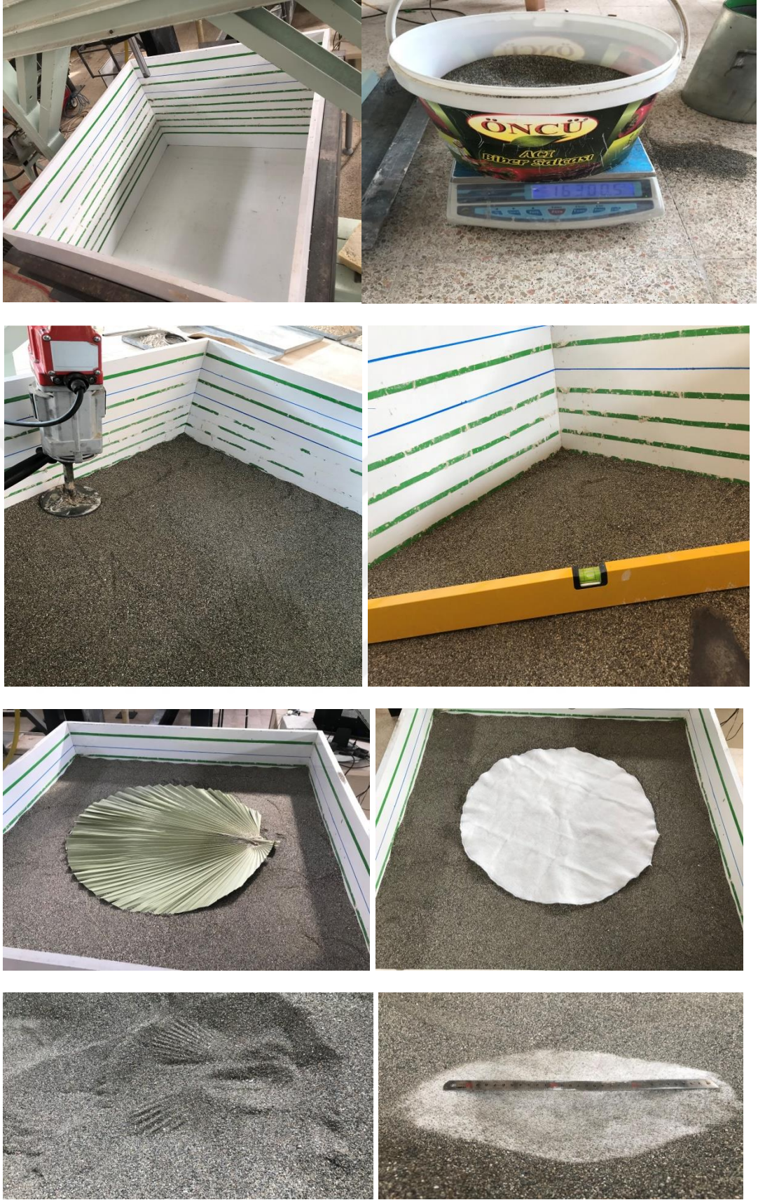
Şekil 3.6 500 mm taban zemine sahip geotekstil ve PTPW ile güçlendirilmiş deney
