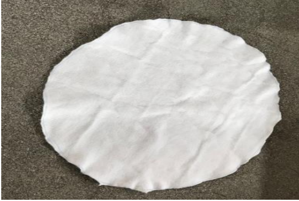
Şekil 3.4 PTPW boyutunda 600 mm kesilmiş geotekstil
