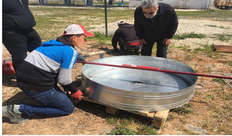
Şekil 3.9. A sınıfı buharlaşma kabının deneme alanına yerleştirilmesi
