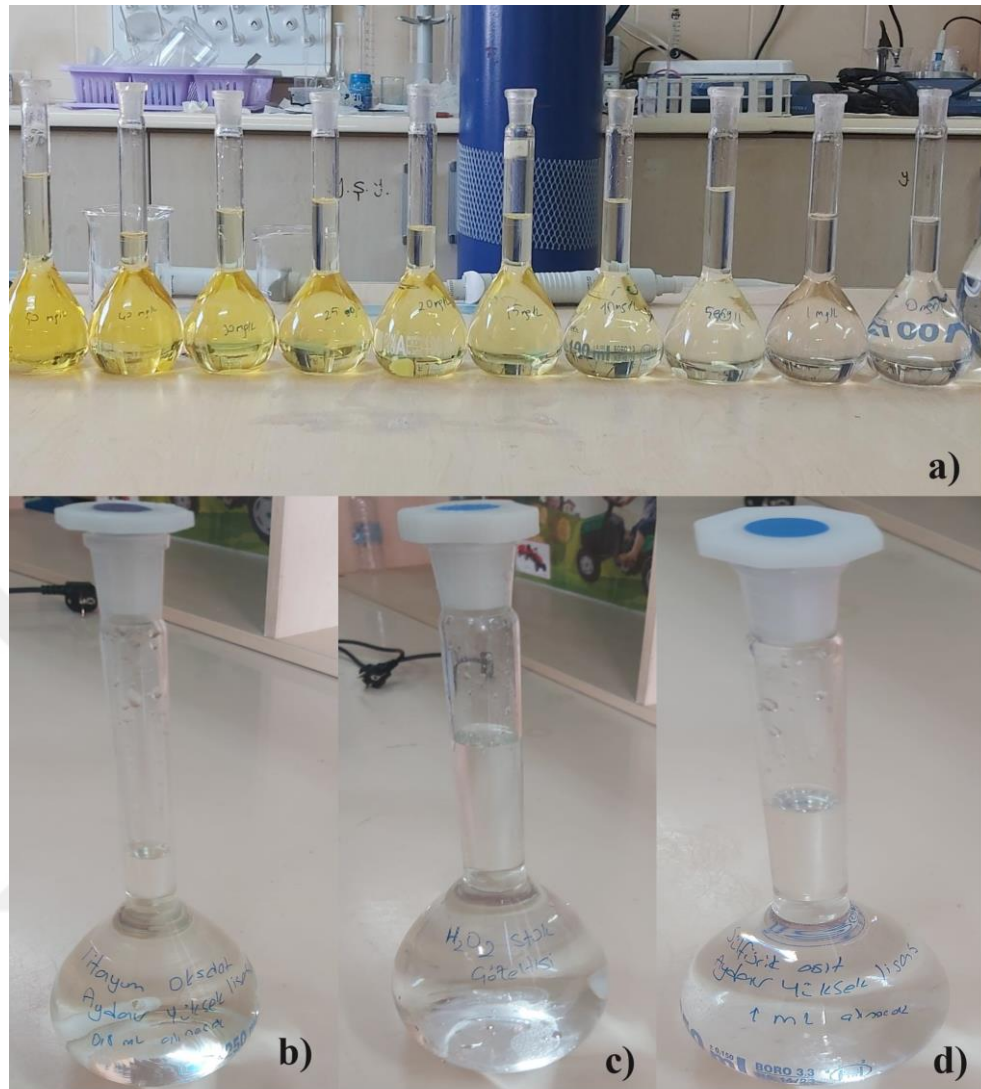
Şekil 2.4. Elektrokimyasal olarak üretilen H_2O_2 miktarının Spektrofotometre de ölçümü İçin Gerekli Kimyasal Çözeltiler ve H_2O_2 Çözeltileri. a) Kalibrasyon için kullanılan farklı konsantrasyonlarda H_2O_2 çözeltileri b) Titanyum oksalat çözeltisi c) H_2O_2 stok çözeltisi d) Sülfürik asit çözeltisi
