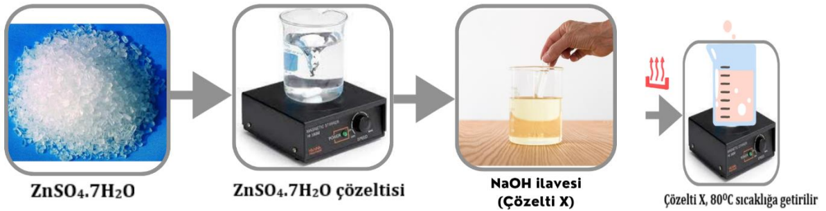
Şekil 2.5. ZnO nanoparçacıklarının sol-jel tekniği ile eldesi
