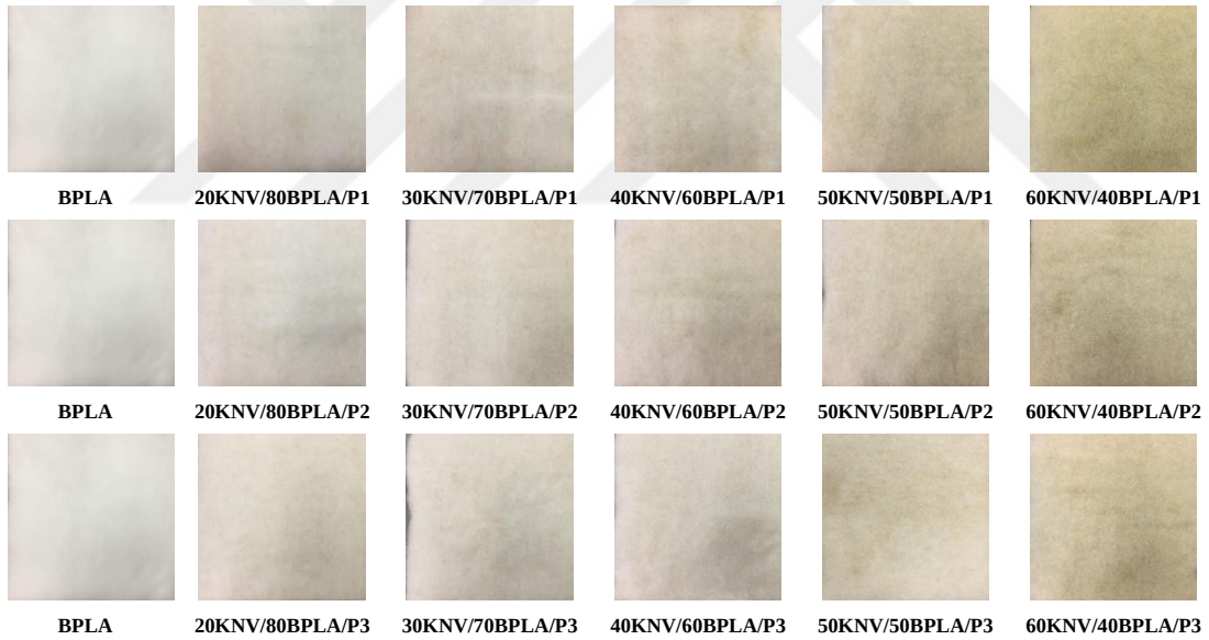
Şekil 2.6. Bicomponent PLA Lifi İle Kenevir Liflerinin Taranmış Tülbent Formları
