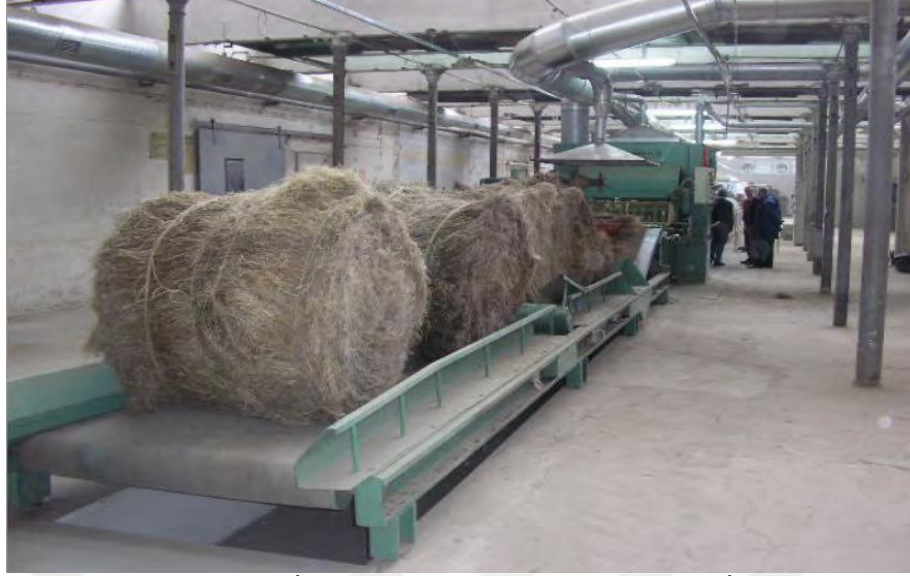
Şekil 1.21. Keten İşleme Prosesindeki Balya Açma İşlemi [33].
