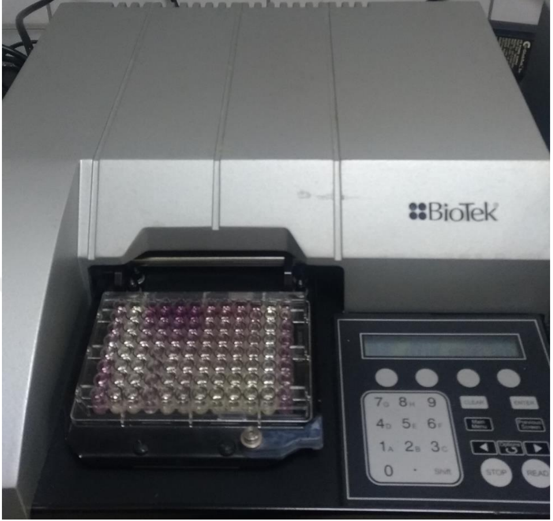
Şekil 3.6 MTT testi: Biotek marka mikropılaka okuyucuda örneklerin okunması.
