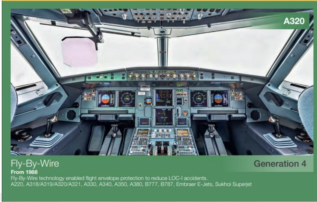
Şekil 29. Dördüncü Nesil Kokpit Görünümüne Ait Bir Örnek (Airbus, 2023, s. 17).
