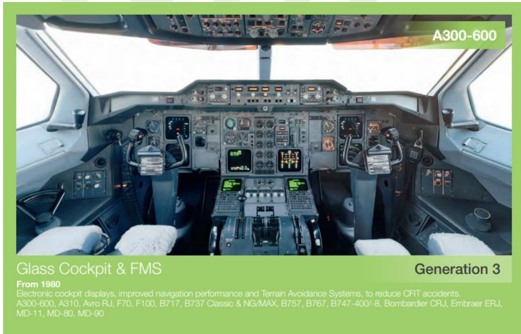
Şekil 28. Üçüncü Nesil Kokpit Görünümüne Ait Bir Örnek (Airbus, 2023, s. 16).
