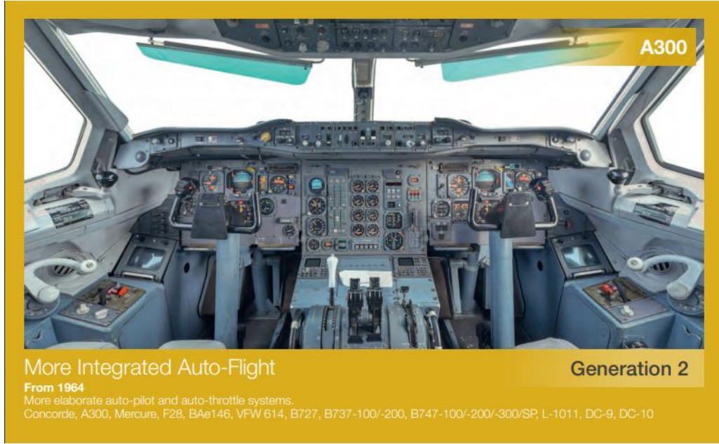
Şekil 27. İkinci Nesil Kokpit Görünümüne Ait Bir Örnek (Airbus, 2023, s. 17).
