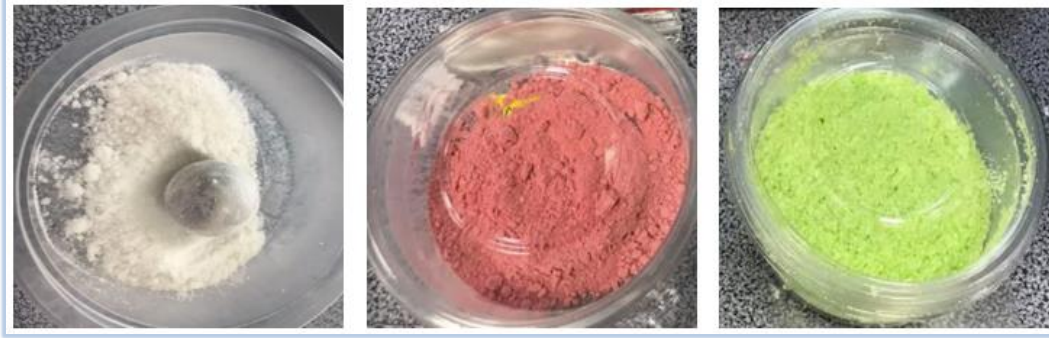
Şekil 4.3. Nylon66, PVC ve PP' nin sırasıyla mikrotoz formları.
