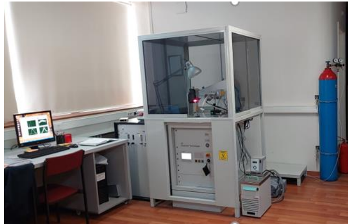
Şekil 3.1. HECUS System3 SWAXS deney sistemi.
