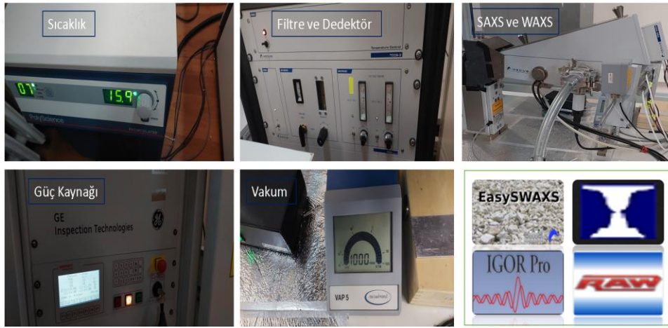
Şekil 3.2. HECUS System3 SWAXS sistem bileşenleri [42, 43].
